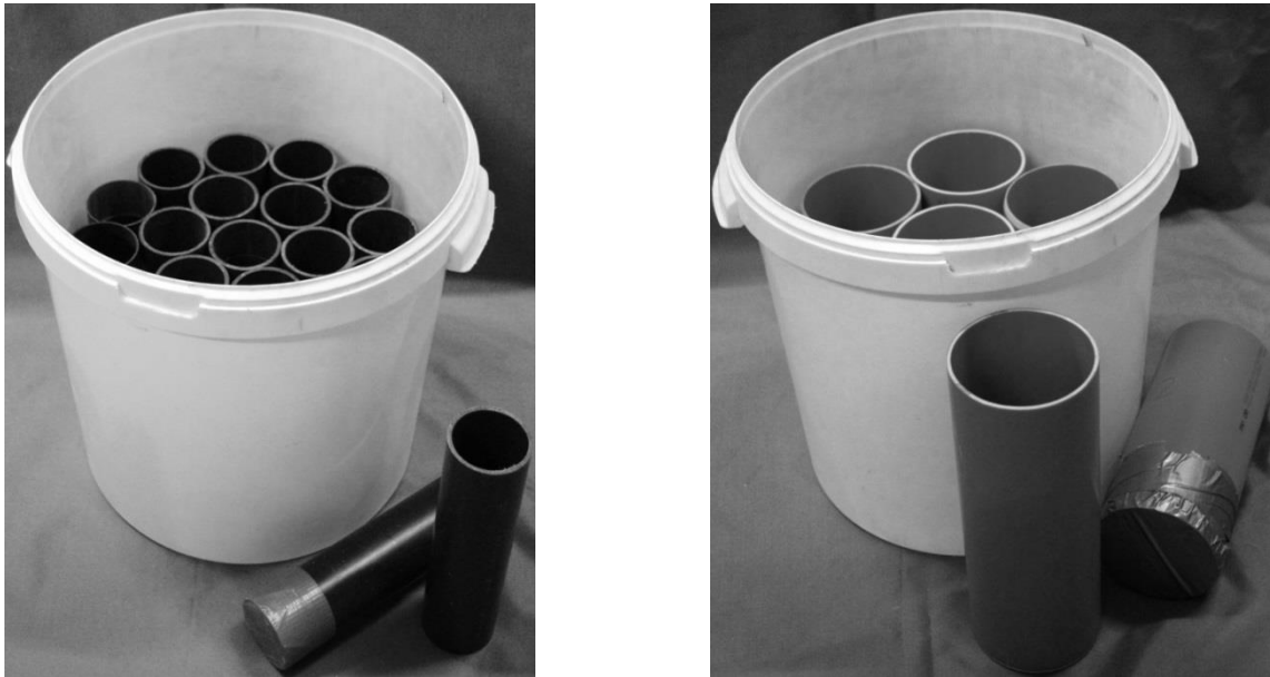
Abbildung 3.1: PVC-Einmalschalung für die zylindrischen Proben, links H/D = 180 mm/60 mm, rechts H/D = 300 mm/100 mm
