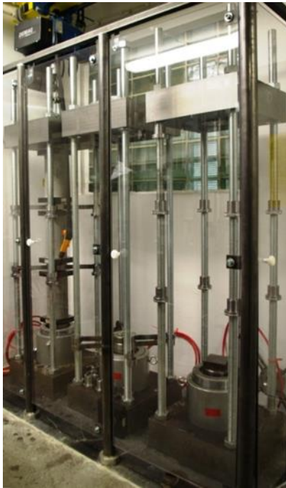
Abbildung 3.10: Vier-Säulen Prüfraumen (drei Stück) für die Kriechversuche
