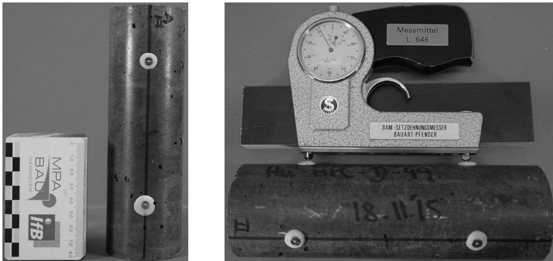
Abbildung 3.8: Probekörper zur Bestimmung des Trocknungsschwindmaßes (links), Probekörper mit aufgesetztem Setzdehnungsmesser (rechts)
