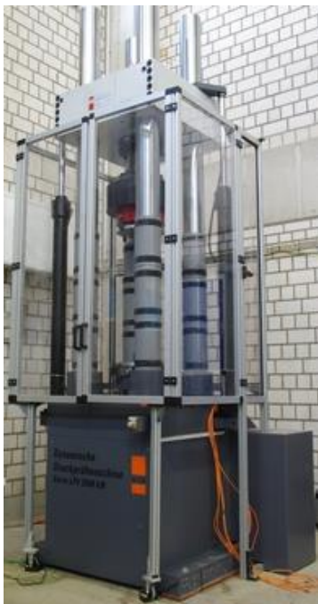
Abbildung 3.9: 2,5 MN servohydraulische Universalprüfmaschine (links) und 5 MN servohydraulische Universalprüfmaschine (rechts)
