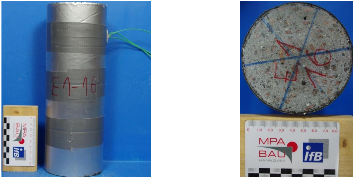
Abbildung 6.11: Versiegelter Probekörper in der Ansicht, links und in der Draufsicht, rechts
