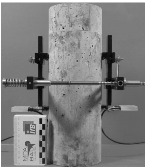
Abbildung 3.14: Versuchsaufbau zur Bestimmung des statischen Elastizitätsmoduls
