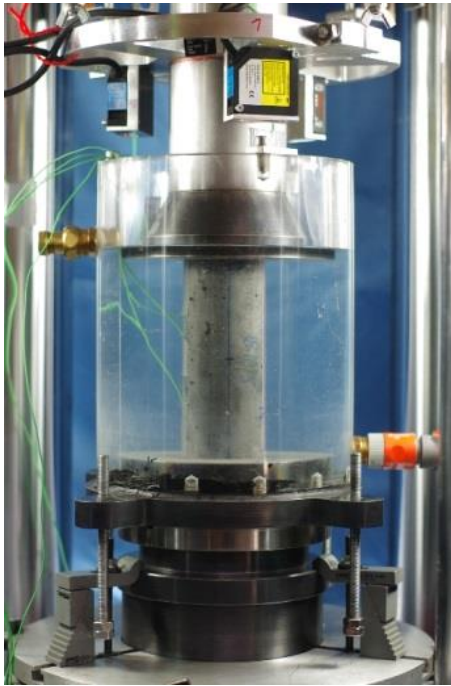
Abbildung 3.12: Versuchsaufbau in der 2,5 MN servohydraulischen Universalprüfmaschine, Betonzylinder H/D = 180 mm/60 mm
