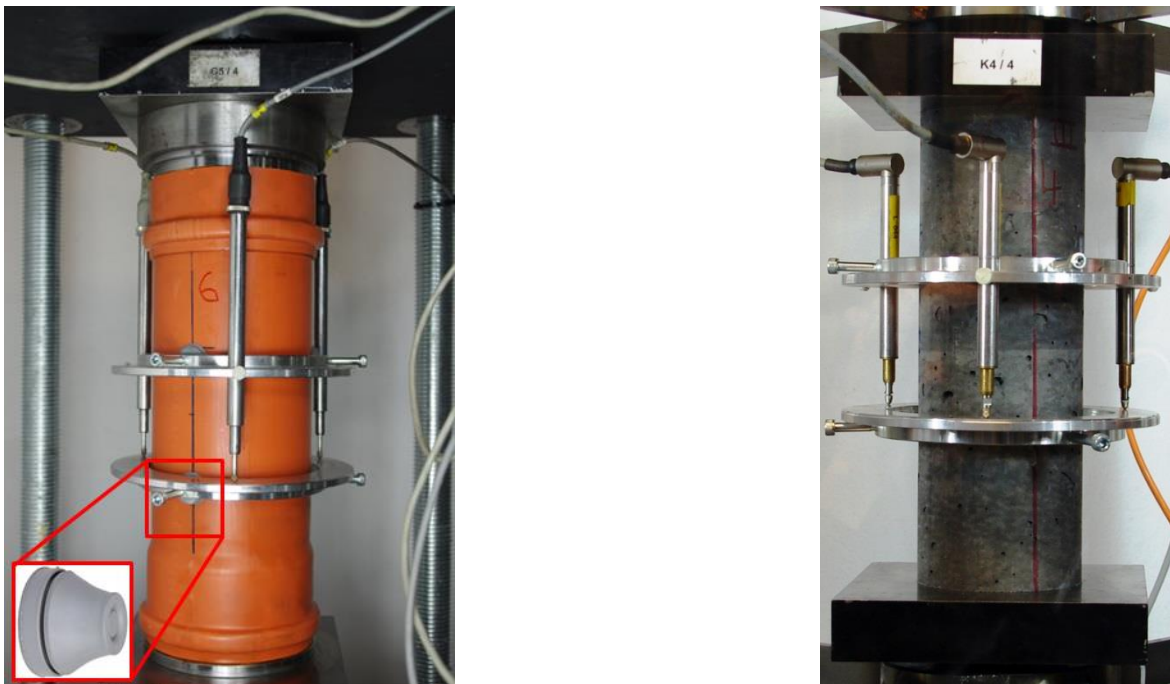
Abbildung 3.13: Versuchsaufbau für die Kriechversuche unter Wasser (links) und in trockener Umgebung (rechts)
