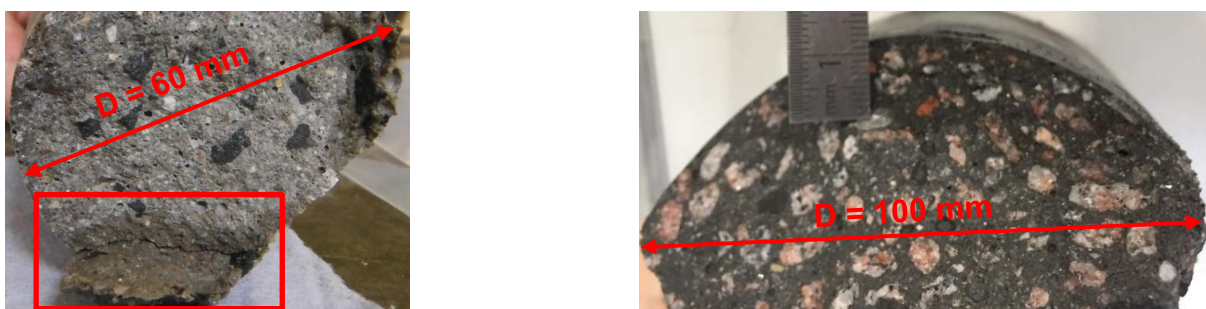
Abbildung 6.5: Vergleich der Wassereindringfront beim Erreichen eines bestimmten Dehnungs- bzw. Schädigungszustands für eine hochfeste Vergussmörtelprobe ( H/D = 180 mm/60 mm) [81], links, und eine Probe aus HPC mit D = 100 mm, rechts
