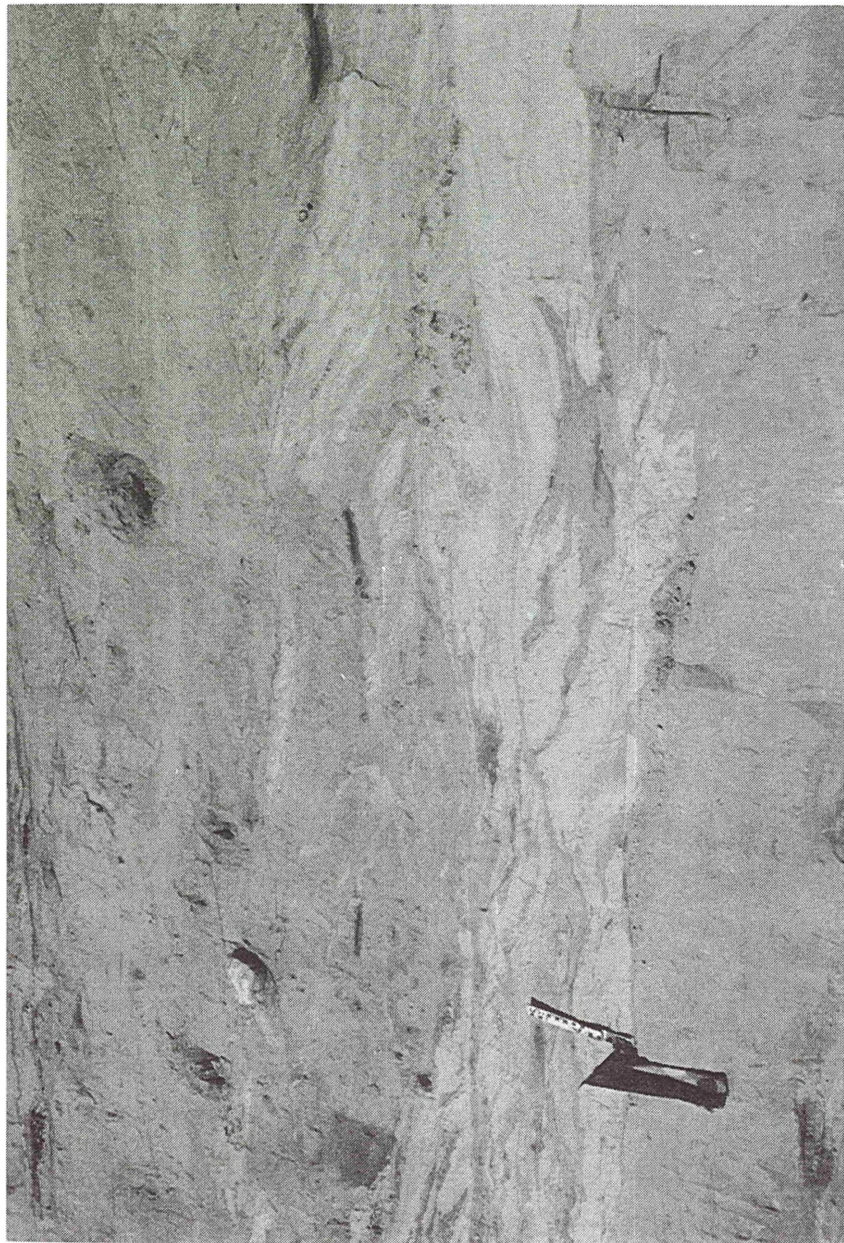
Taf. 17: Freißbüttel: qe(2), Sg mit Scherzone bestehend aus Fein- bis Mittelsand (hell) und Geschiebesand (dunkel); (Bewegungsrichtung nach links; Stab: 25 cm); vgl. Taf. 4 bei 5 m
