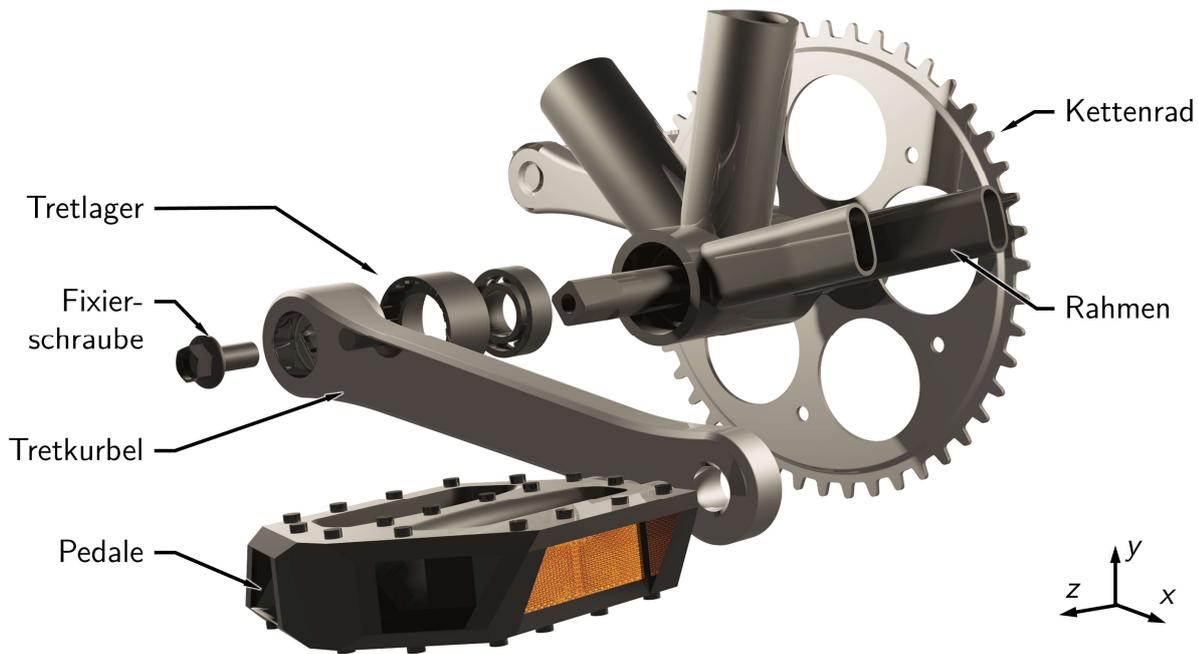
Abbildung 6.1: Komponentendarstellung der Kurbelgarnitur eines Fahrrads
