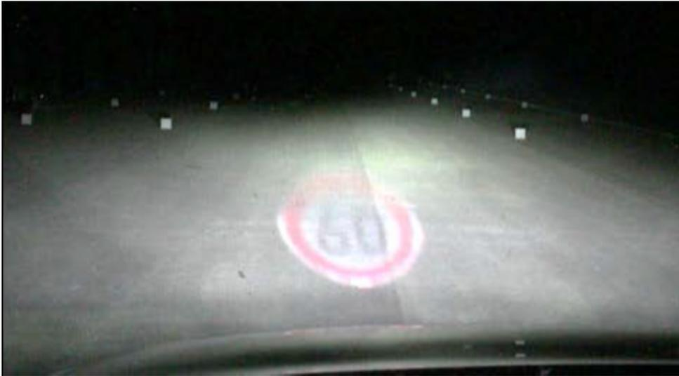
Abbildung 6.15: Projektion von Zeichen 274-56 nach StVO (Zulässige Höchstgeschwindigkeit 60 km/h) [ROTH15]
