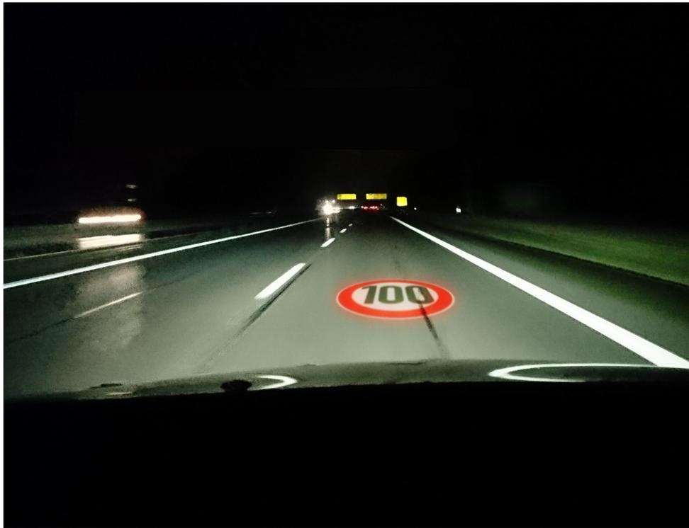
Abbildung 3.2: Beispielhafte Projektion der zulässigen Maximalgeschwindigkeit
