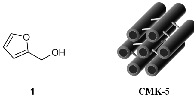
Abb. 4: Schematische Darstellung von CMK-5 (rechts) und Valenzstrichformel des für die Herstellung verwendeten Kohlenstoffpräkursors Furfurylalkohol.
