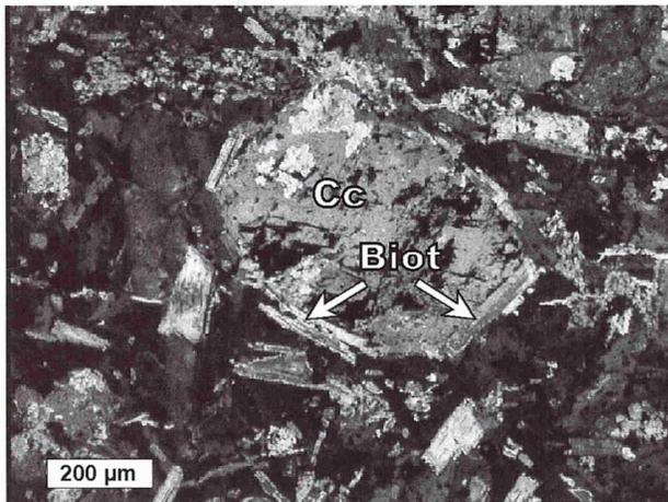
**Abb. 14** - Kalzitpseudomorphose nach Biotit im biotitreichem Gang-Dazit. Am Rande des ersetzten Kristalls sind noch Reste von Glimmer erkennbar. Probe Sob-2. Biot: Biotit, Cc: Kalzit. Nicols x.
