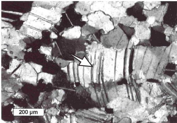
**Abb. 33** - Durch übergreifende Zwillingslamellen erkennbarer „Urkristall“ (Pfeil) nach der dynamischen Kornverkleinerung. Die Kristallbegrenzungen neuer Subkörner sind durch unterschiedliche Auslöschung im polarisierten Licht gekennzeichnet. Probe P-39. Nicols x.
