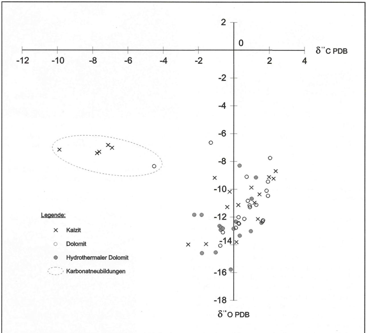
**Abb. 73** - Graphische Darstellung der Ergebnisse von O-, C-Isotopenuntersuchung des Kauffunger Kalksteins. Zu den „Karbonatneubildungen“ zählen: subrezente Kalzit-Travertintapete, kalzitische Drusenfüllung im Hydrothermalen Dolomit und die „Satteldolomit-Sprossung“ (Präparat 1.16).
