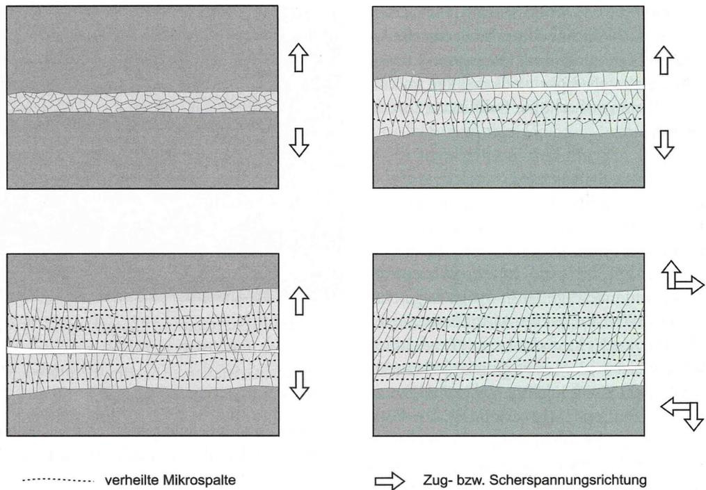
**Abb. 47** - Prinzip der Entstehung von faserigen, nahtlosen Kluffüllungen, die infolge wiederholten Aufreißens und Zementierens von Spalten gebildet werden (crack-seal growth sensu Passchier & Trouw, 1996).
