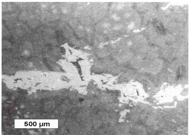
**Abb. 56a** - Kathodolumineszenz eines Dolomit-Marmors. Die dunkelgrauen Farbtöne entsprechen einer tief roten, die hellen einer hell roten Farbe. Zu erkennen ist eine sekundäre dolomitische Zementation (hell). Probe NR-6.
