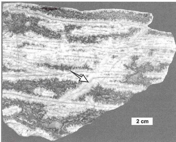
**Abb. 63** - Polygonale „Dolomitsepten“ (Pfeil) mit konzentrischen, kalzitisch-dolomitisch-sideritischen Zementationen von ehemaligen Freiräumen (Zellen). Tagebau Połom. Verändert nach Skowronek & Wrobel (2001).
