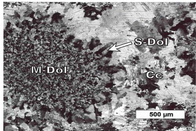
**Abb. 71b** - Dünnschliffaufnahme aus der isotopisch untersuchten Probe KB-6S (Vorkommen Silesia). M-Dol: Dolomit-Klast (Matrix-Dol.-Typ), S-Dol: Satteldolomit-Zement, Cc: Kalzit. Nicols x.
