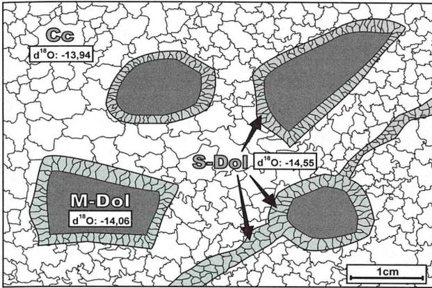
**Abb. 71a** - Schematische Darstellung einer kalzitisch/dolomitischen Brekzie mit ermittelten  $\delta^{18}\text{O}$ -Werten der karbonatischen Gesteinsanteile (Probe KB-6S, Steinbruch Silesia). M-Dol: Dolomit-Klast (Matrix-Dol.-Typ), S-Dol: Satteldolomit-Zement, Cc: Kalzit.
