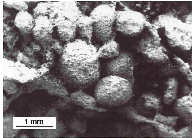
Abb. 75 - REM-Aufnahme des dolomitisch/kieseligen Gesteins mit Quarz-Rundkörpern. Lokalität: Berg Wapnik.
