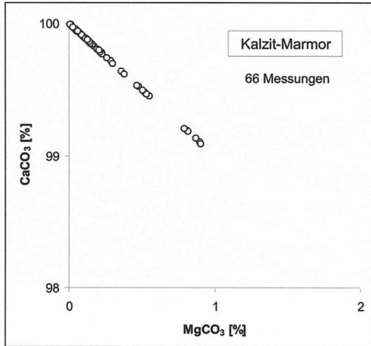
Abb. 25 - Chemische Zusammensetzung von Kalzit-Kristallen des Kalzit-Marmors (Mikrosonde).
