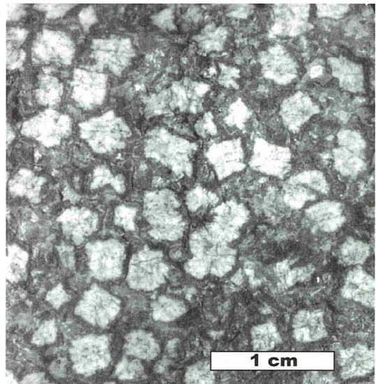
**Abb. 64a** - Pseudoporphyrische Textur aus mm-großen Dolomitaggregaten, eingebettet in einer kalzitisch-sideritischen Matrix. Tagebau Połom. Aus Skowronek & Wrobel (2001).
