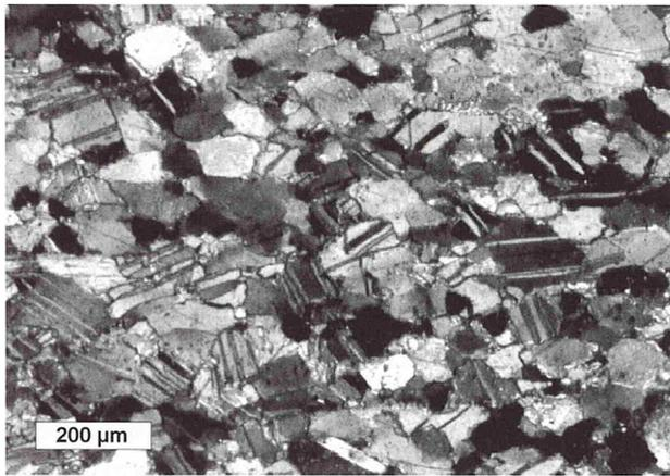
**Abb. 21** - Mittelkristalliner Kalzit-Marmor mit verzwillingten, horizontal schwach eingeregeltten Kalzitkristallen und equigranularer Kornverteilung sowie wenig suturierten Korngrenzen. Probe P-20. Nicols x.
