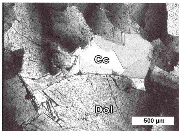
Abb. 66 - Dolomitisch-kalzitische Zementation im zentralen Bereich einer Druse. Satteldolomitzemente weisen erhebliche Krümmung der äußeren Kristallflächen. Im Zentrum: Kalzitischer Blockzement. Cc: Kalzit, Dol: Dolomit. Probe P-30. Nicols x.
