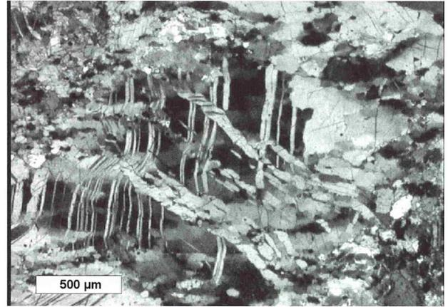
Abb. 28 - Zwei Generationen duktil deformierter Zwillingslamellen von Typ III (nach Passchier & Trouw, 1996). Probe GM-1. Nicols x.
