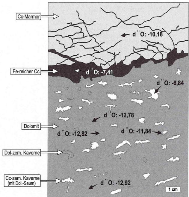
**Abb. 72** - Schematisierte Skizze vom Kontakt: Hydrothermaler Dolomit/Kalzit-Marmor mit Probeentnahmepunkten (Pfeile) für die O-, C-Isotopie. Probe P-56. Verändert nach Skowronek & Wrobel (2001).
