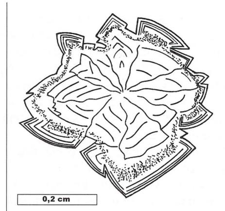
**Abb. 64b** - Schematisierte Detaildarstellung des radialstrahligen Dolomitaggregats (Satteldolomittyp, siehe mikroskop. Beschreibung) in einem dolomitischen Gestein mit pseudoporphyrischer Textur (Abb. 64a). Dargestellt: ein Fe-Hydroxid-Band (gepunktet) und Zonar-Aufbau von randlichen, leicht gekrümmten Kristallbereichen.
