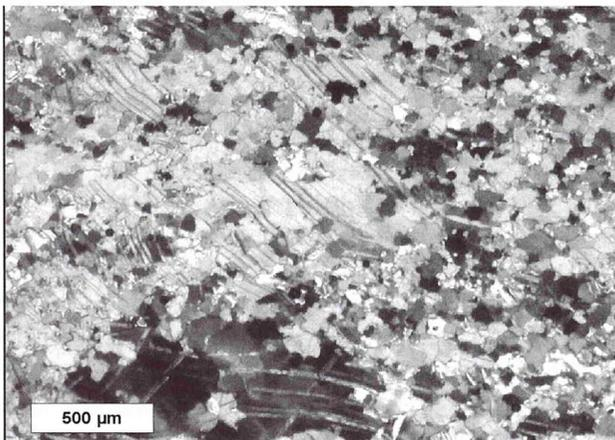
**Abb. 23** - Inequigranulare (ungleiche) Korngrößenverteilung im Kalzit-Marmor, Probe Sob-5, Nicols x.
