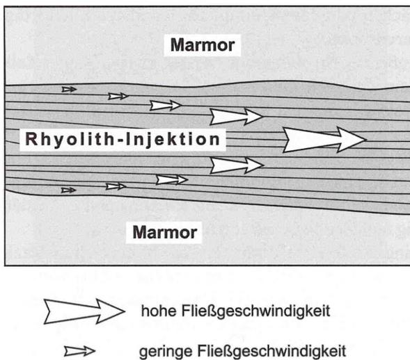
**Abb. 13** - Entstehungsmodell des Parallel-Gefüges der in den Kauffunger Kalkstein eingedrungenen Rhyolith-Gänge. Höhere Reibungskräfte in äußeren Spaltenbereichen verlangsamen die Fließgeschwindigkeit der injizierten Lava (laminares Fließen).
