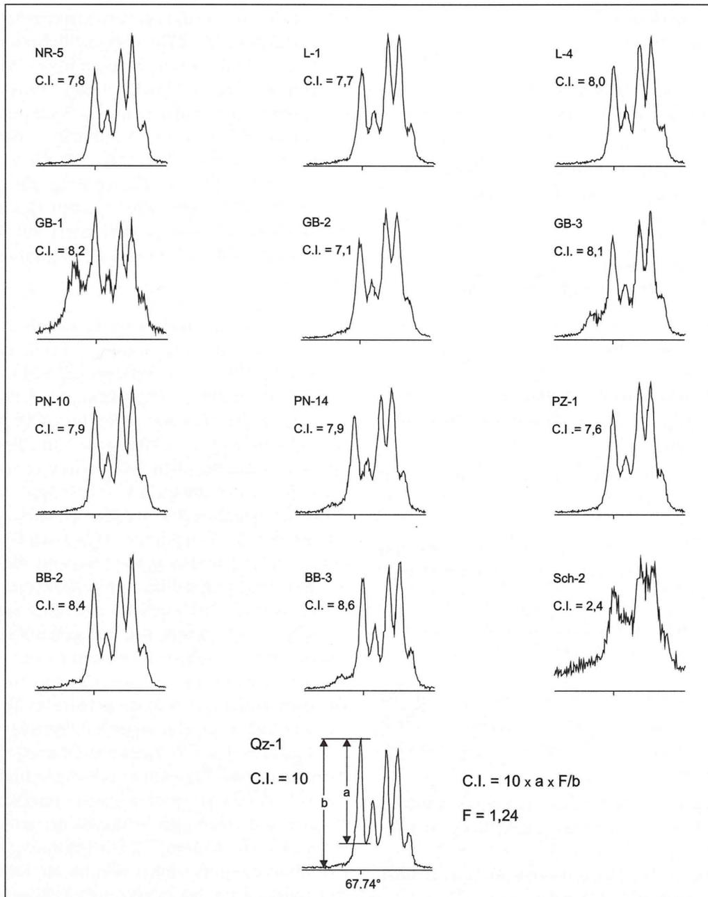
Abb. 77 - Röntgendiagramme und Quarz-Kristallisationsindex (C.I.) von untersuchten Qz-reichen Lithotypen (Petrographie siehe Tab. 5). Unten: Prinzip der C.I.-Ermittlung.
