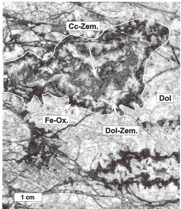
**Abb. 61** - Kalzitverschlossene Kavernen im Hydrothermalen Dolomit mit Säumen von braunen Fe-Ox-Verbindungen. Tagebau Połom. Cc: Kalzit, Dol: Dolomit, Zem.: Zement. Verändert nach Skowronek & Wrobel (2001).
