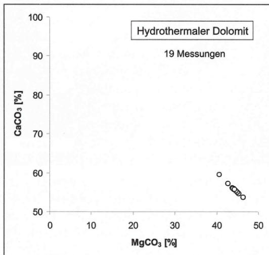
**Abb. 68** - Chemische Zusammensetzung des Hydrothermalen Dolomits.
