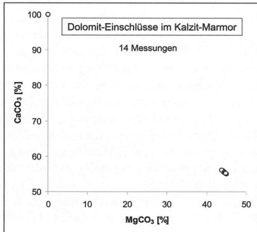
Abb. 26 - Chemische Zusammensetzung der dolomitischen Einschlüsse im Kalzit-Marmor (Mikrosonde).
