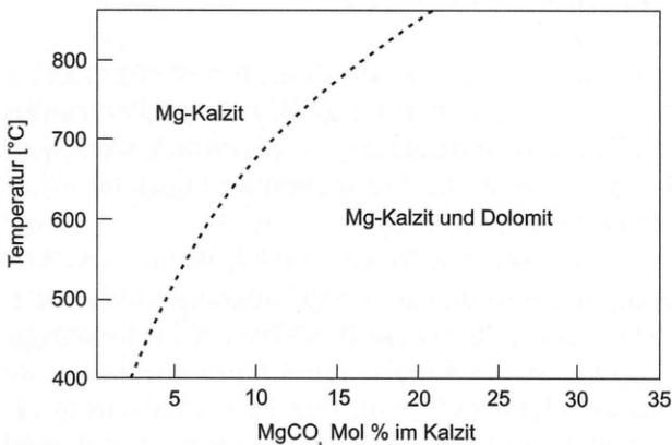
**Abb. 35b** - Detaildarstellung des Kalzit/Dolomit-Solvus für Temperaturbereiche bis etwa 900 °C. Verändert aus Goldsmith & Newton (1969).
