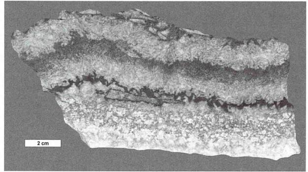
**Abb. 60** - Sekundäre, dolomitisch-ankeritische Zementationen (eines größeren Hohlraums?). Tagebau Połom.
