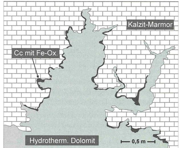
**Abb. 58** - Schematisierte Aufschlußskizze eines hydrothermalen Dolomitkörpers. Rhyolithischer Gang nicht aufgeschlossen. Abbauwand Tagebau Połom. Verändert nach Skowronek & Wrobel (2001).
