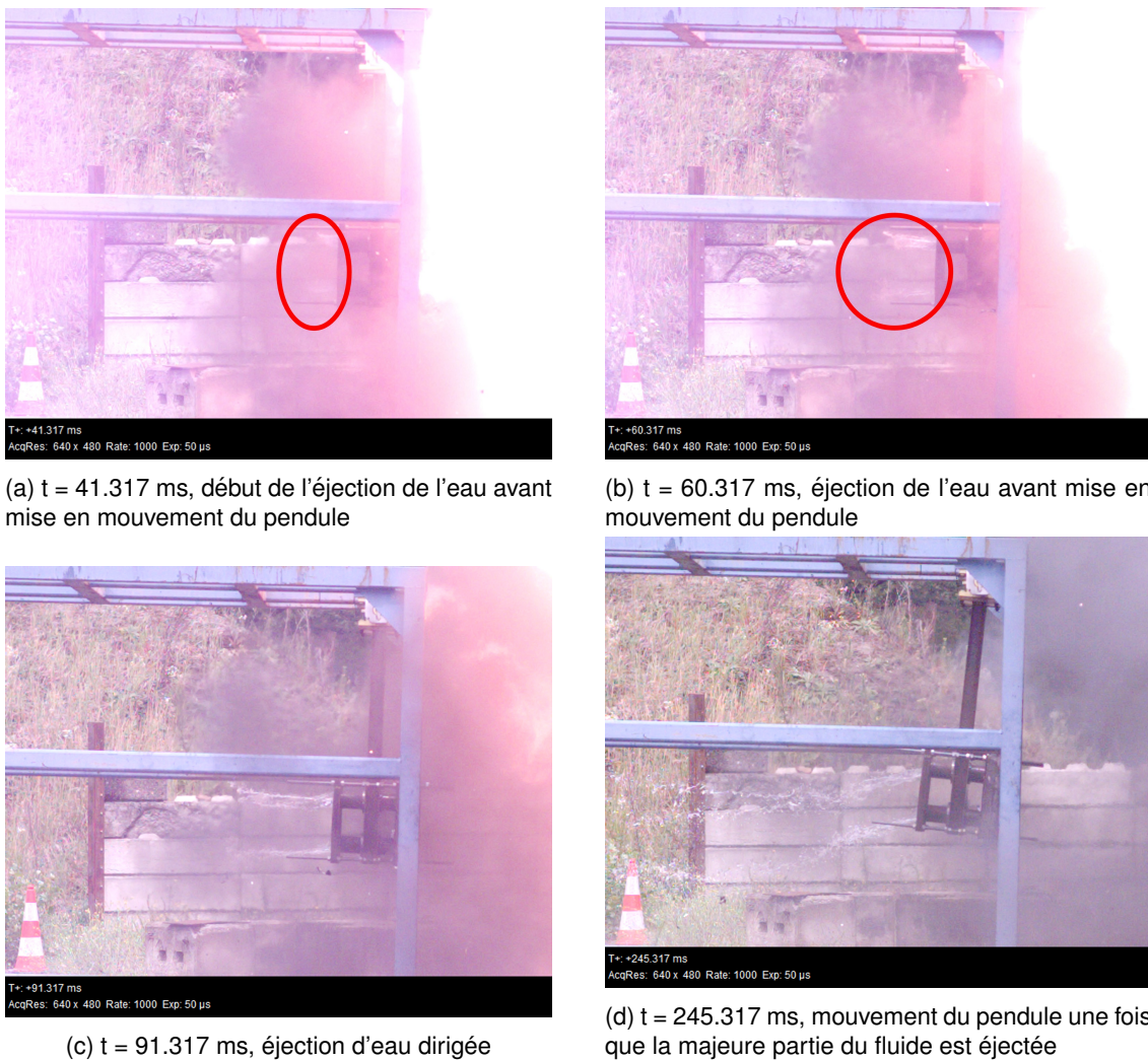
Figure A.15: Images de la caméra haute vitesse de la première oscillation du pendule pour l'expérience Ta265
