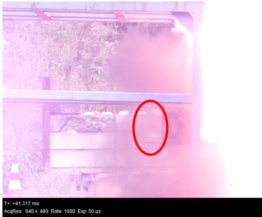
(a) t=41.317 ms, beginnender Wasserausstoß, bevor das Pendel in Bewegung versetzt wird
