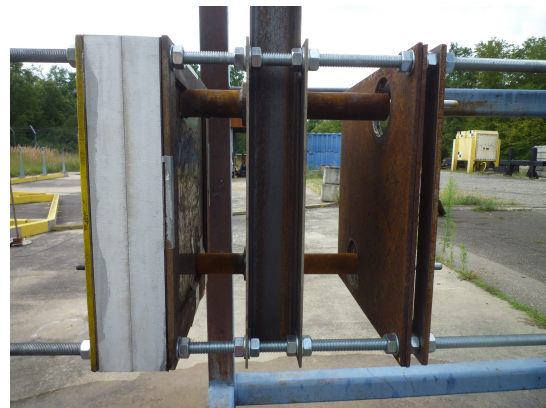
(b) Nouvelle configuration expérimentale avec confinement latéral du fluide avec un cadre en aluminium
