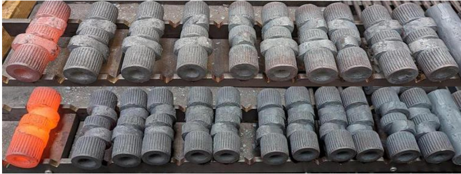
Bild 7: Walzergebnis für das Ellipsen (oben) und Exzenter (unten)
