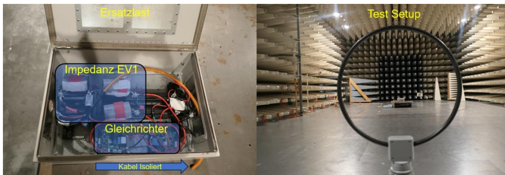
Abbildung 8 Links: Ersatzlast mit Gleichrichter und Kompensation auf der Karosserienachbildung; Rechts: Testsetup Magnetfeldmessung WPT-System
