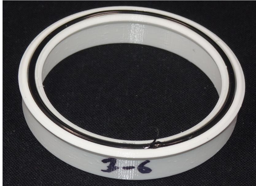
Abbildung 7.1: Kompaktring-Testteil mit additiv gefertigter TPU- und NBR-Komponente
