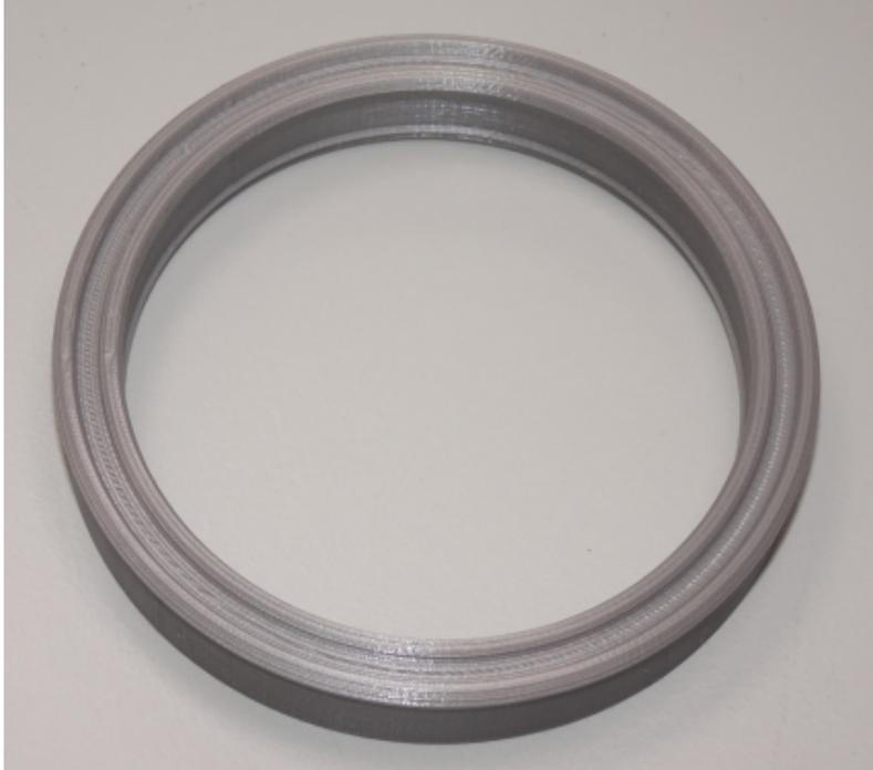
Abbildung 5.2: Erste Vorversuche: Testteil aus dem Filament Fillamentum Flexfill TPU98A
