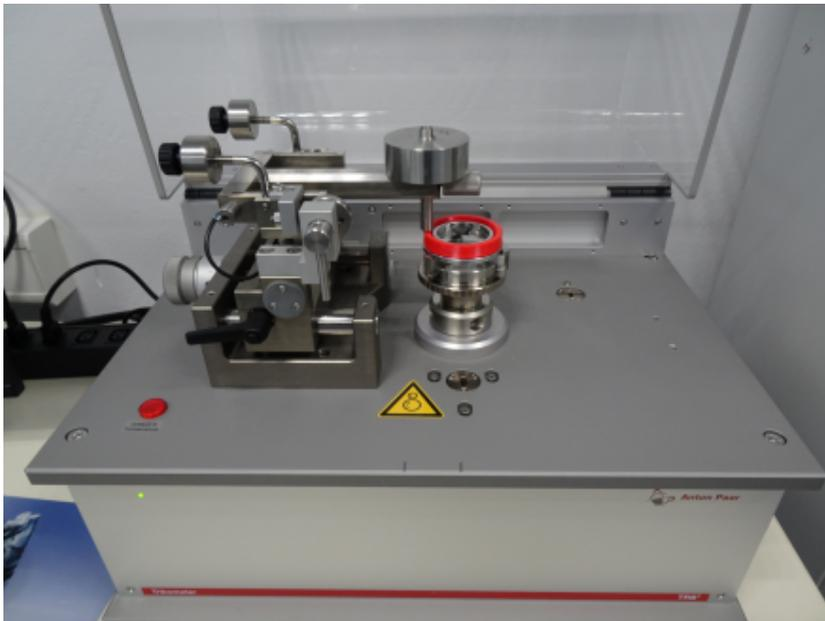
Abbildung 4.1: Tribometer Anton Paar TRB<sup>3</sup> der HS Emden-Leer
