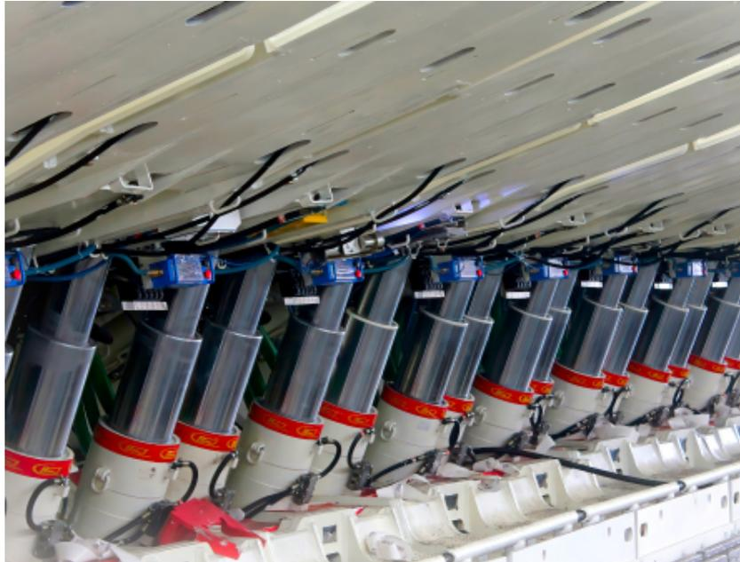
Abbildung 1.2: Hydraulikanwendung (Schildausbau) im Bergbau (Quelle: EEP Elektro-Elektronik Pranjic GmbH)
