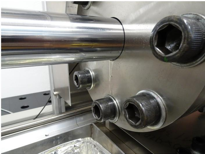
Abbildung 5.7: Leichter Fluidaustritt (optisch erkennbar unterhalb des Stangenaustritts aus der Druckkammer)
