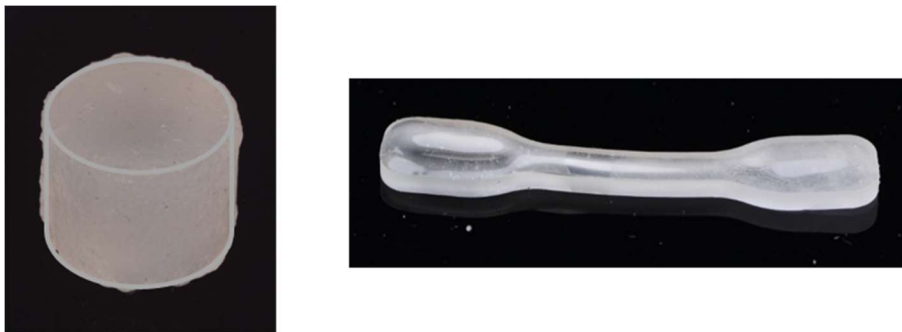
Abbildung 35: Fotografische Aufnahmen der aus PGS hergestellten Probenformen. Links : Eine zylindrische Probenform ( d = 16 mm; h = 15 mm), welche gänzlich in der Mikrowelle synthetisiert wurde. Rechts : Ein konventionell hergestellter und quervernetzter Probenkörper nach S3A (DIN 53504), wie er in den uniaxialen Zugprüfungen verwendet wurde.
