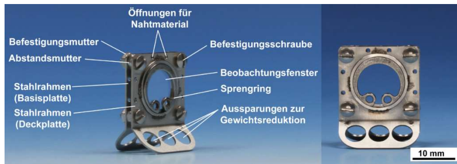
Abbildung 11: Eine Rückenhautkammer zur Untersuchung von Implantaten. Sie besteht aus zwei Teilen mit einem Beobachtungsfenster für die Mikroskopie. (Zur Verfügung gestellt von Dr. ANDREAS KAMPMANN)
