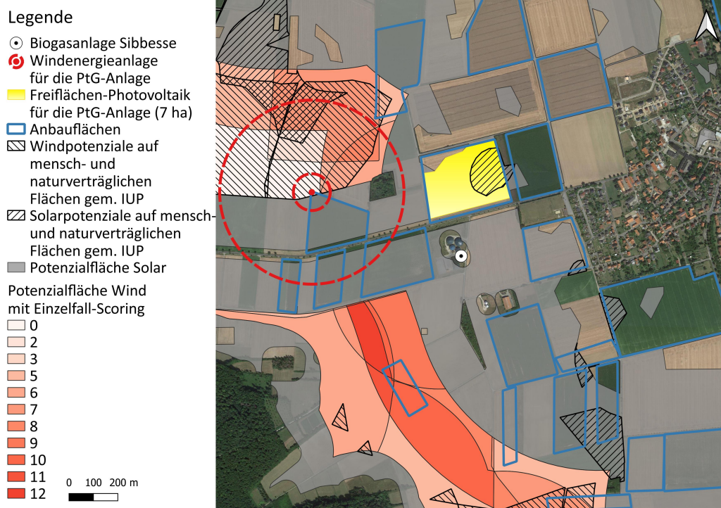
Abb. 4.19: Layout der WEA (1x) und FF-PVA (7 ha) für die BGA Sibbesse unter Einbezug mensch- und naturverträglicher Flächen nach IUP sowie Anbauflächen der Biogasanlage. Abstände WEA: 2,5 x Rotordurchmesser. Eigene Darstellung.
