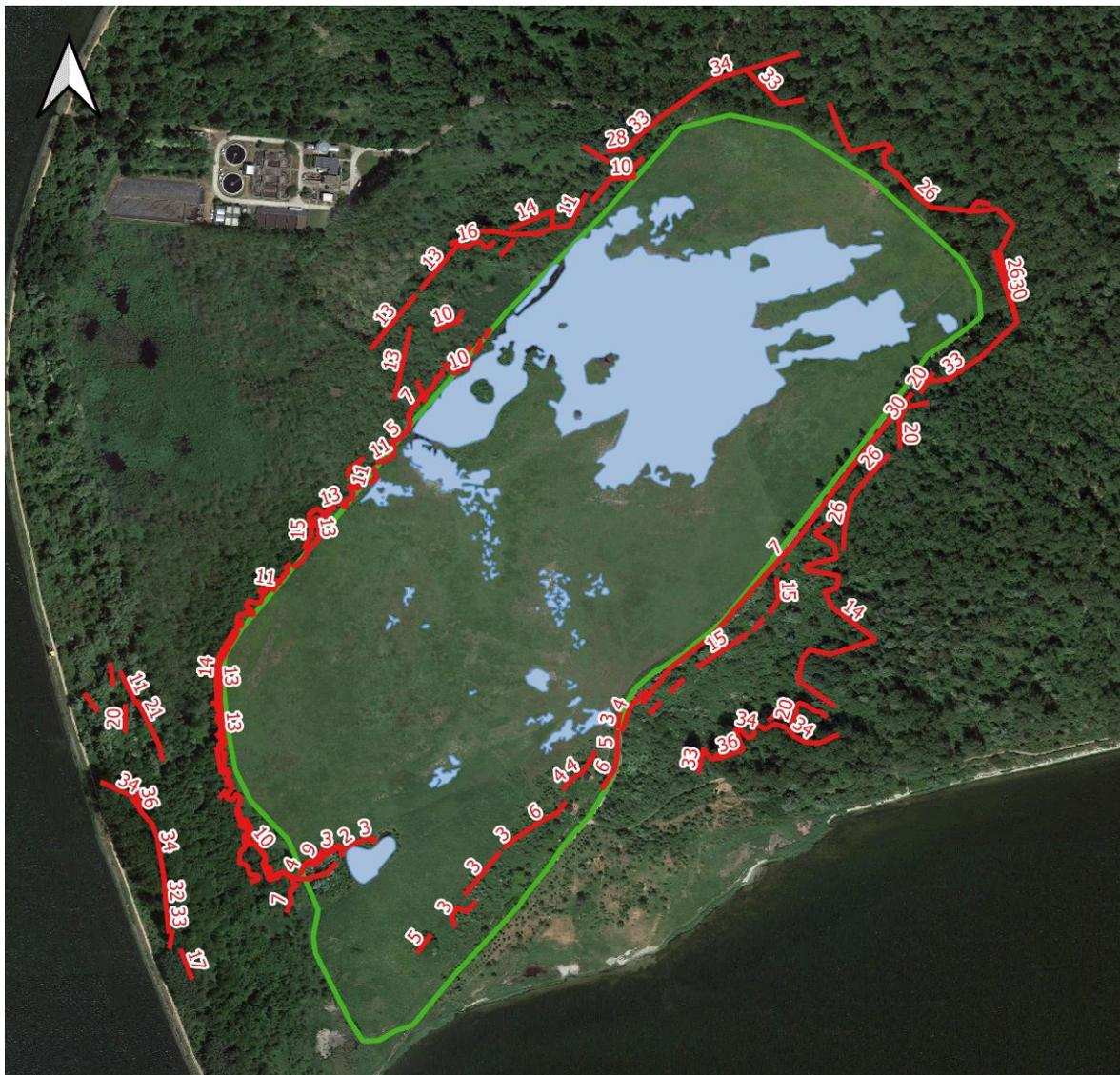
Abbildung 3.2: Waldrandhöhe (m) um die zentrale Wiese im NSG „Südlicher Priwall“ (2015), Ergebnisse der Photomessung mit einer Drohne.
