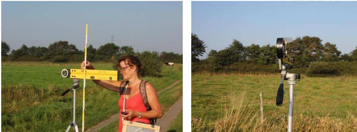
**Abbildung 2.1: Baumhöhenmessung.** Der untere Schenkel des Winkelmeßgerätes wird mit der integrierten Wasserwaage ausgerichtet, über den oberen Schenkel kann sodann der Baumwipfel angepeilt werden. Die Standhöhe wird hinzuaddiert (Tollenmoor, Kreis Nordfriesland, 9. Juli 2017).
