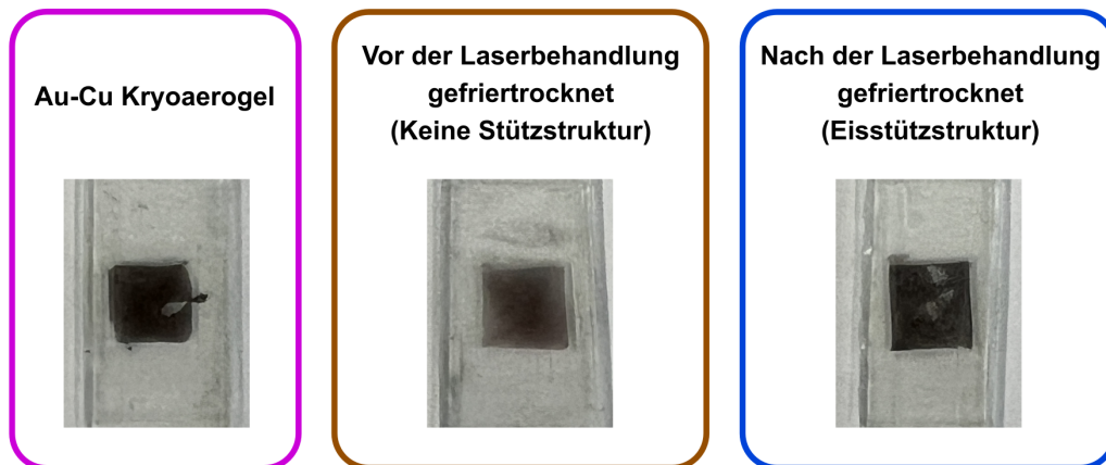
Abbildung 9.2: Fotos der Au-Cu Kryogele auf einem ITO beschichteten Glassubstrat. Das vor der Laserbehandlung getrocknete Au-Cu Gel (B) weist im Vergleich zu dem unbehandelten (A) und im gefrorenem Zustand laserbehandelten Gel (C) eine deutlich hellere Farbe auf.
