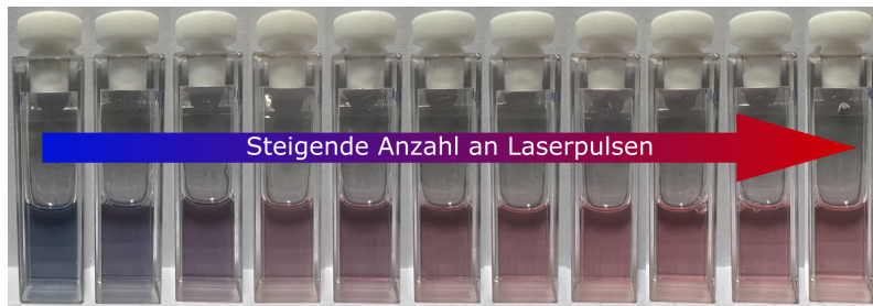
Abbildung 5.5: Die Farbe der kolloidalen Lösung von Goldnanoprismen in Wasser wechselt während der Laserbehandlung von tiefblau zu rot.
