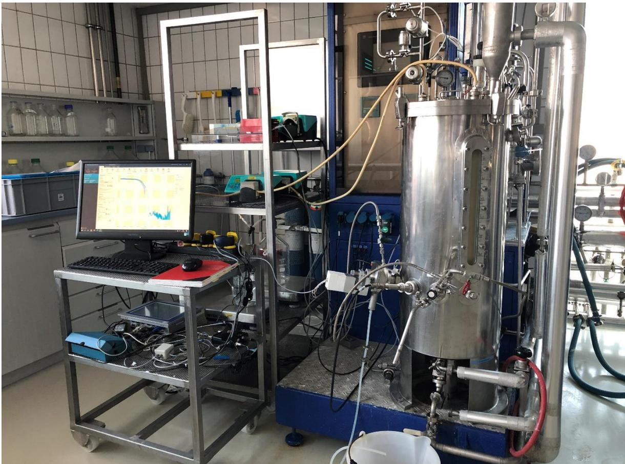
Abbildung 32 – Eingebautes ISICOM mit Auswertungsrechner in der 50 L Pilot Anlage bei Chr. Hansen
