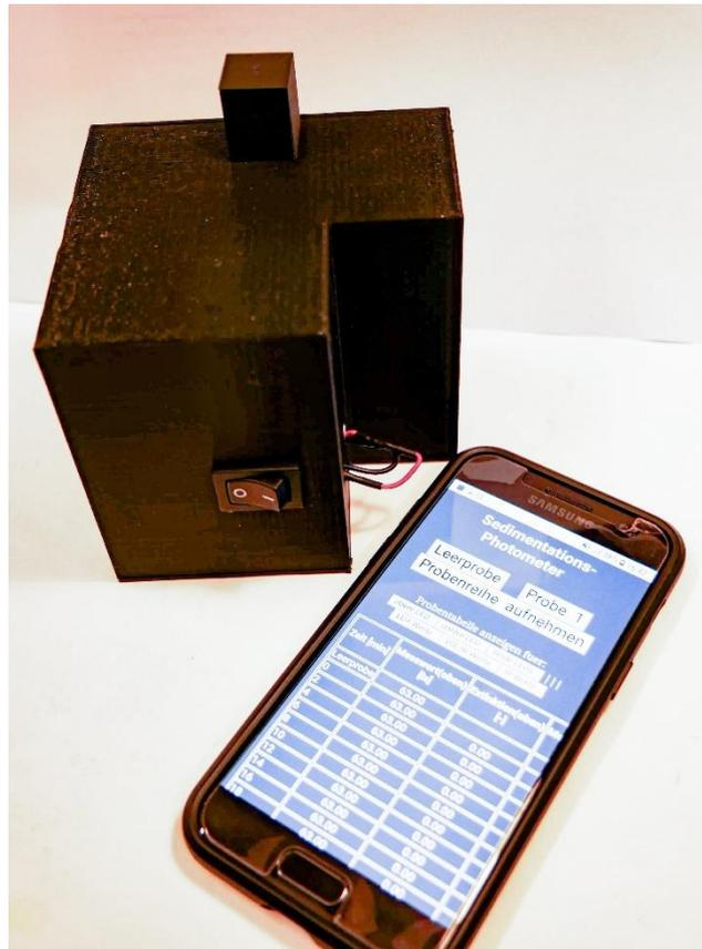
Abbildung 26 - Sedimentationsphotometer (Nico Ulber 2019)
