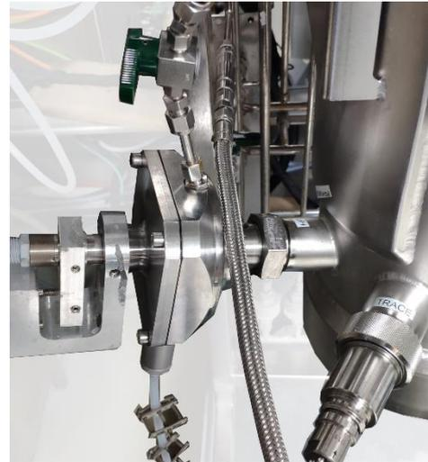
Abbildung 13 – ISICOM eingebaut in Bioreaktor im Ingoldport (Dahlmann et al. 2020)
