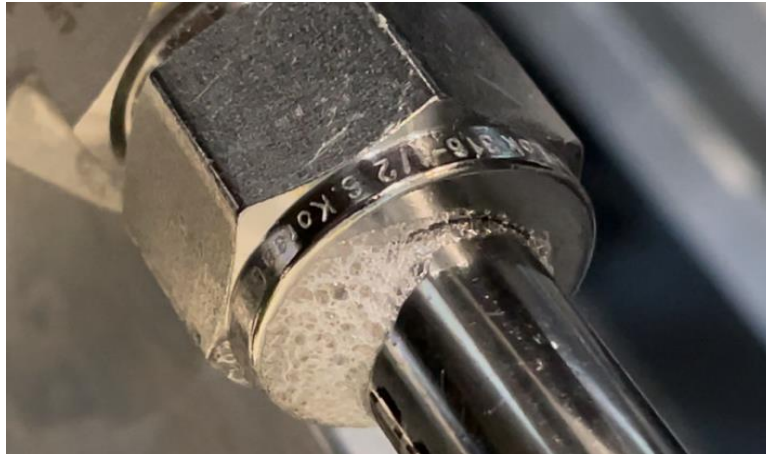
Abbildung 7.1: Leckage Identifizierung durch Lecksuchmittels.
