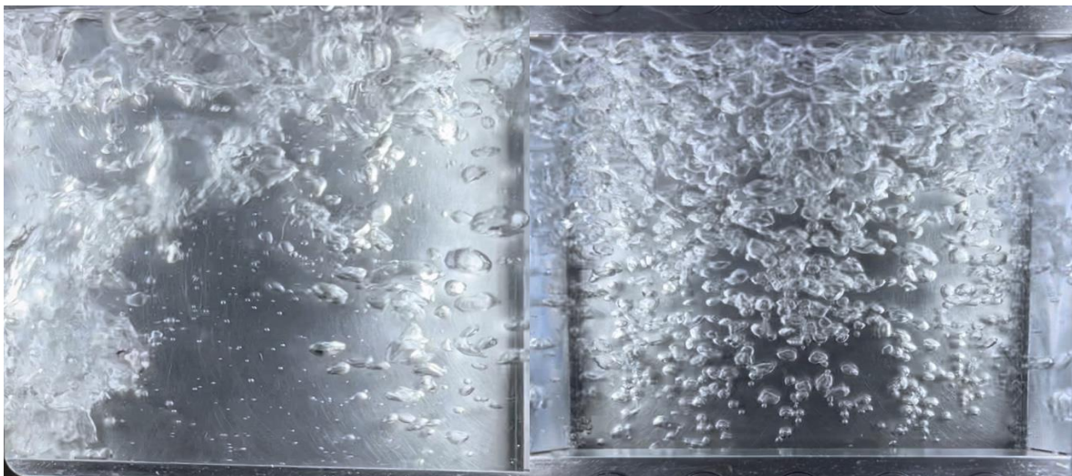
Abbildung 7.5: Verdampfung bei unterschiedlichen Dampfgehalten.
