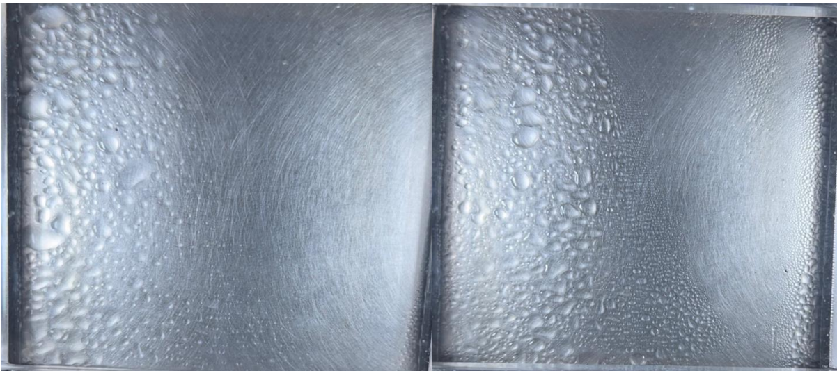
Abbildung 7.4: Kondensation bei unterschiedlicher Wassertemperatur.
