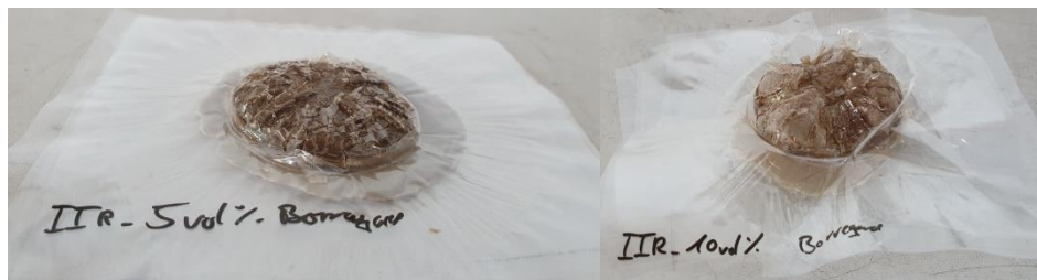
Abbildung 92: Deformierte vulkanisierte IIR-NFC-Prüfkörper, die 5 (links) und 10 Vol.% (rechts) NFC enthalten.
