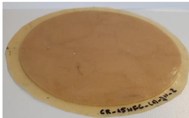
Abbildung 74: CR-NFC-Prüfkörper für Permeationsmessungen mit einem Füllstoffgehalt von 15 Vol.%.
