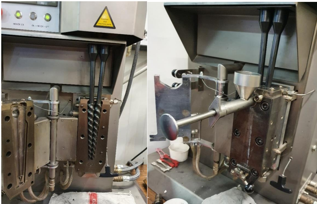
Abbildung 94: Aufgeklappter Microcompounder mit eingesetzten Förderschnecken (links) und zugeklappter Microcompounder mit angebaute Beschickungseinheit (rechts).
