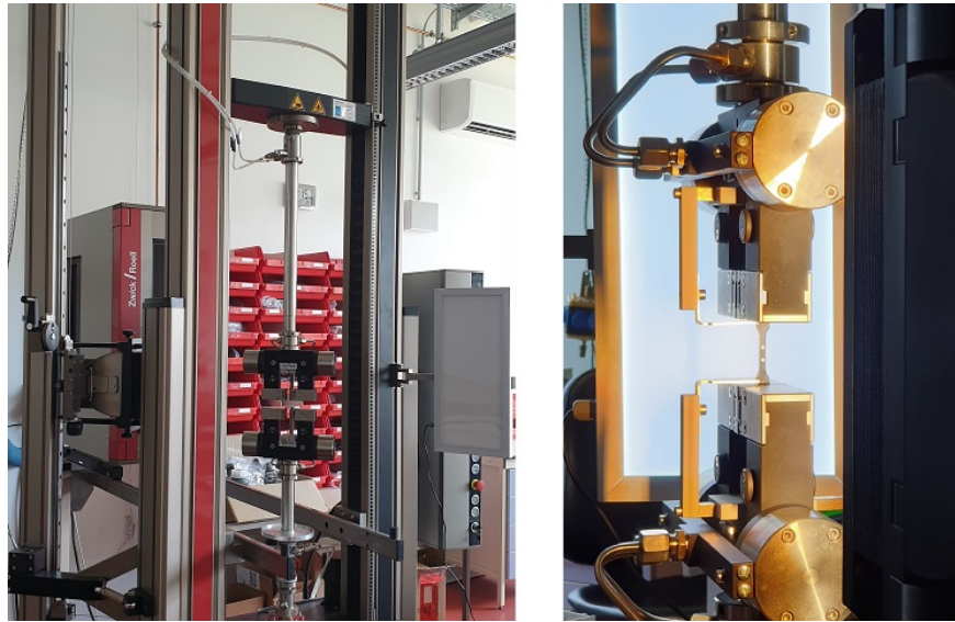
Abbildung 4.5: Universal-Zugprüfmaschine Z010 von Zwick Roell zur Bestimmung von u. a. der Reiß- und Weiterreißfestigkeit und Reißdehnung.
