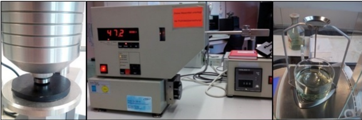
Abbildung 4.3: Links: Härteprüfung mit Kegelstumpfindenter nach DIN ISO 7619-1. Mitte: Messgerät für die Rückprallelastizität nach DIN 53512. Rechts: Aufbau für die Dichteprüfung nach DIN EN ISO 1183-1 Verfahren A.
