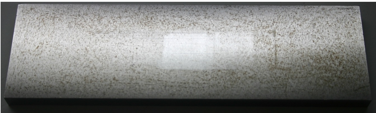
Abbildung 5.22: Gezeigt ist eine Stahloberfläche der Stahlsorte C45, die für die stationären Reibmessungen verwendet wurde.
