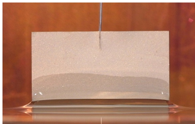
Abbildung 4.13: Darstellung der Wilhelmy-Platten-Methode mit einem Platin-Iridium-Plättchen für die Bestimmung der Grenzflächenenergie einer Flüssigkeit.
