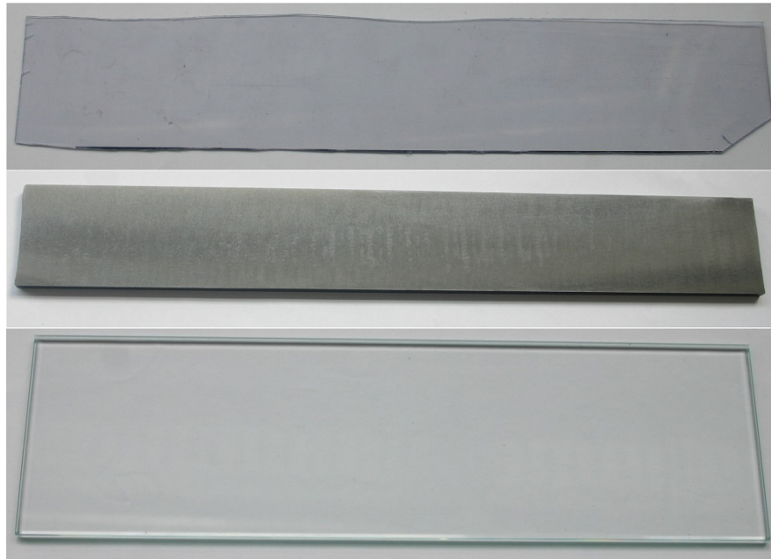
Abbildung 5.37: Verwendete Gegenlaufflächen. Oben: Hart-PVC. Mitte: Stahl (MnCrV8). Unten: Floatglas.
