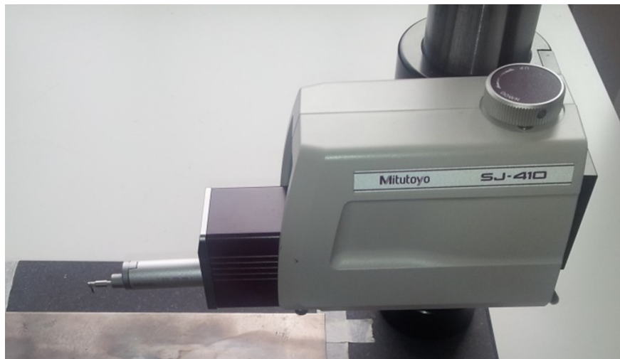
Abbildung 4.8: Für diese Arbeit verwendetes Tastschnittgerät mit Diamantspitze von Mitutoyo zur eindimensionalen Abbildung von Oberflächenprofilen.
