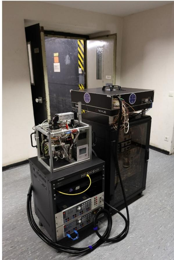
Abbildung 2.2: Vollständigen Atominterferometeraufbau mit Sensorkopf und zugehörigen Elektronik- und Laserracks.
