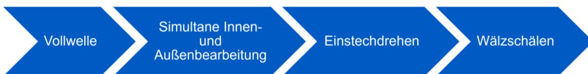
Bild 4-134: Fertigungsschritte zur Herstellung der Zapfenkontur
