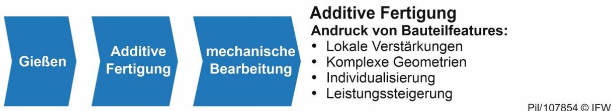
Bild 4-59: Vision Additive Fertigung: Prozesskette für Aluminiumfahrwerkskomponenten
