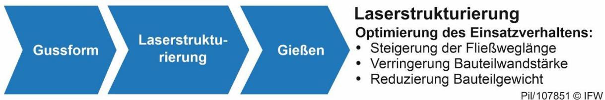
Bild 4-40: Prozesskette Laserstrukturierung
