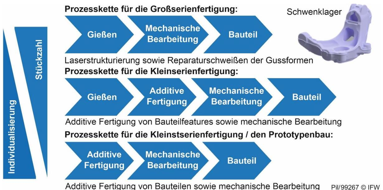
Bild 2-5: Prozessketten zur Fahrwerkskomponentenherstellung
