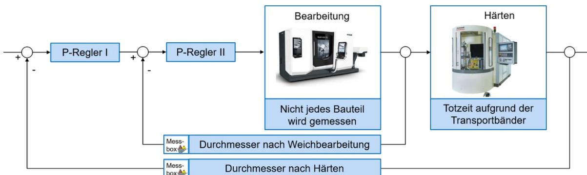
Bild 4-129: Schematische Darstellung der Kaskadenregelung für die Serienfertigung ohne Hartbearbeitung
