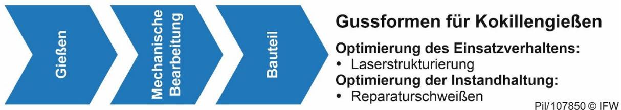
Bild 4-39: Prozesskette Kokillenguss Fahrwerkskomponenten
