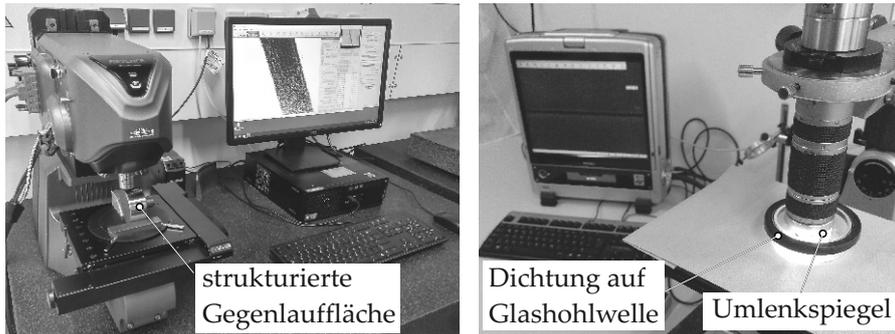
Abbildung 4.8: Messung von Mikrostrukturen am VK-X250 (links) und Dichtkantenbreiten am VHX-600 (rechts)
