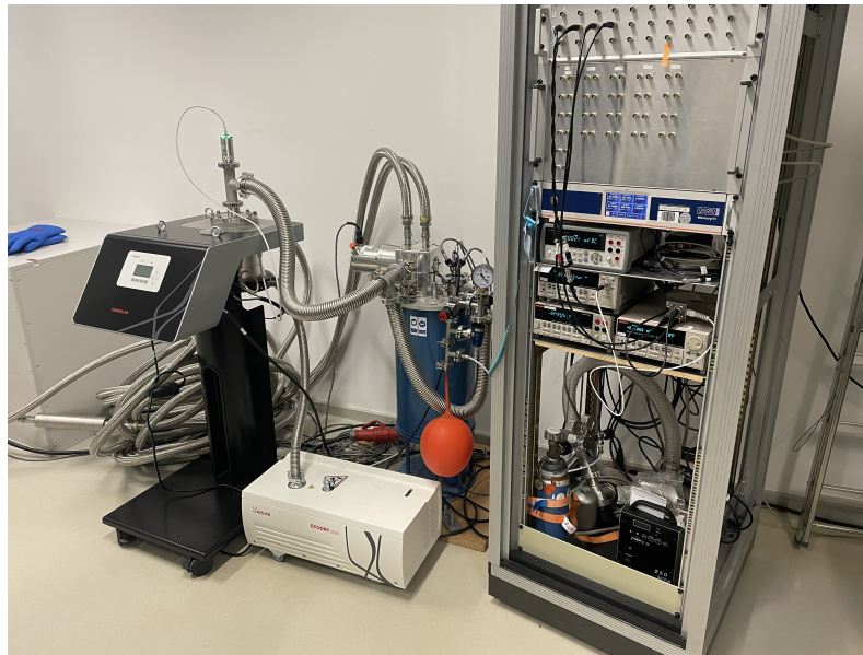
Abb. 3.9.: Der Messplatz besteht aus drei Komponenten. Zunächst ist ganz links die Vakuumpumpe zu nennen, die das Isolier- und Probenvakuum realisiert. In der Mitte befindet sich in blau der eigentliche Kryostat. Rechts folgt ein Rackschrank mit mehreren Messgeräten und einer Kabelverteilerdose zum Anschluss der Probe an die Messgeräte.
