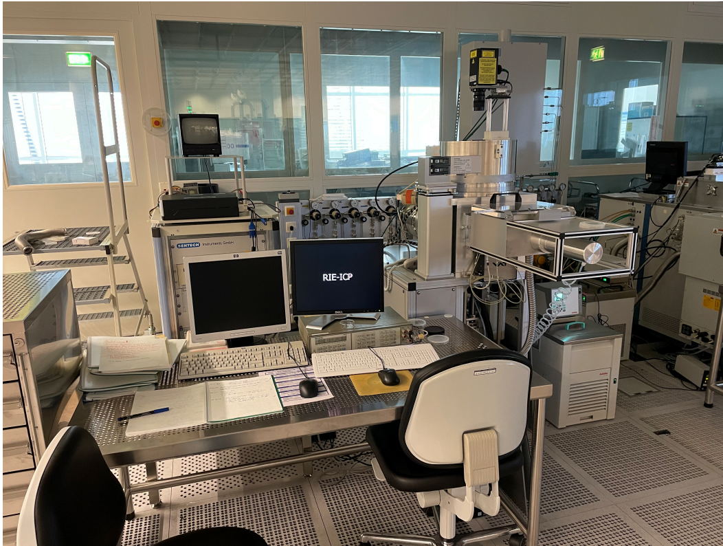
Abb. 3.5.: Aufnahme der ICP-RIE-Ätzanlage des Reinraumzentrums der Physikalisch-Technischen Bundesanstalt in Braunschweig, gebaut von der Firma Sentech.
