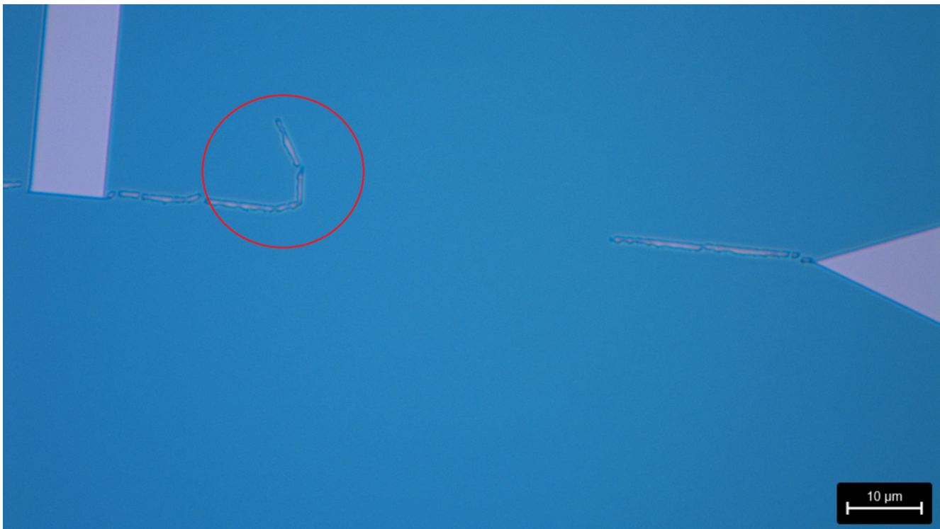
Abb. 4.6.: Eine beschädigte Lackstruktur für einen 200 nm-Steg (Wafer 2), wobei der Lack aufgrund des hohen Aspektverhältnisses umklappt und bei der Entwicklung auch weggeschwemmt wird (mit rotem Kreis markiert). Dadurch kann das Niob nicht mehr entsprechend geätzt werden, wodurch dünne Strukturen eine sehr hohe Ausfallquote haben.
