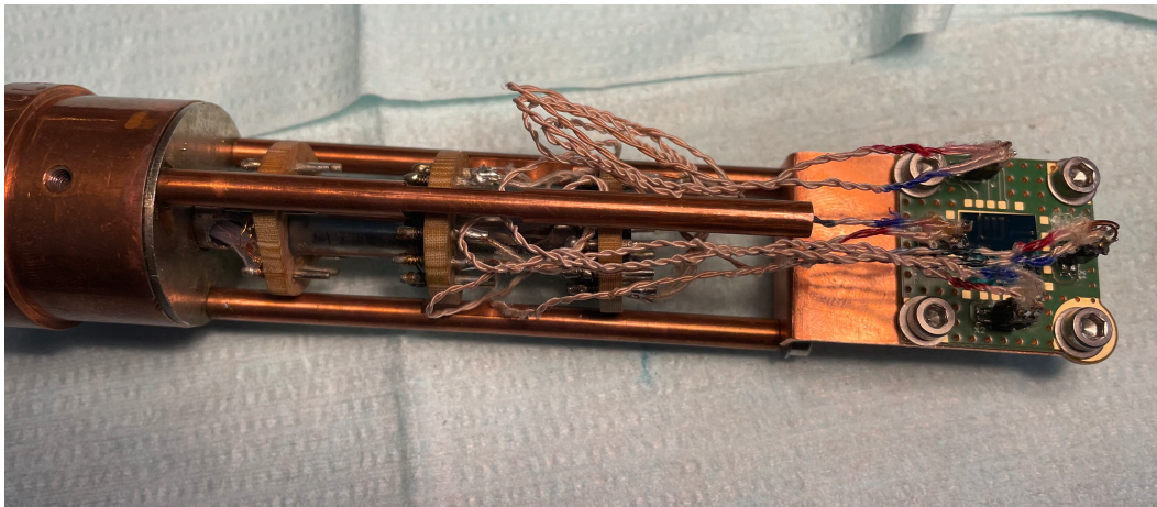
Abb. 3.11.: Rechts auf der grünen Leiterplatte befindet sich die Probe. Seidenisolierte Kupferkabel, von denen immer zwei als Twisted-Pair-Kabel ausgeführt sind, führen zu den Kabeln, die aus dem Kryostat herausführen. Diese münden in den Fischersteckern.
