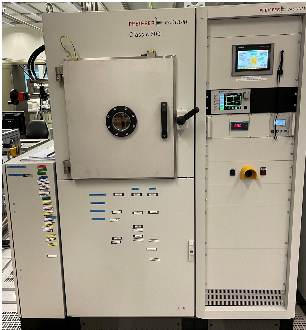
Abb. 3.4.: Aufnahme der thermischen Aufdampfanlage des Reinraumzentrums der Physikalisch-Technischen Bundesanstalt in Braunschweig, gebaut von der Firma Pfeiffer Vacuum.
