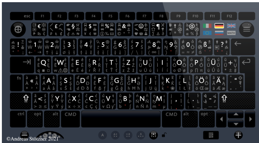
Abb. 5 Konzeptionsentwurf zu einer dynamischen Bildschirmtastatur, mit der bis zu ca. 470 Zeichen unmittelbar manuell ansprechbar sind (©Andreas Stötzner 2021); vgl. Gebrauchsmuster Nr. 20 2022 000 976, Deutsches Patent- und Markenamt München, 9. 6. 2022.
