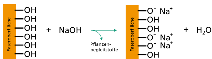
Abbildung 8: Schematische Darstellung der Herauslösung von Pflanzenbegleitstoffen unter Einwirkung von NaOH aus einer cellulosebasierten Naturfaser. (selbst erstellt nach [37])
