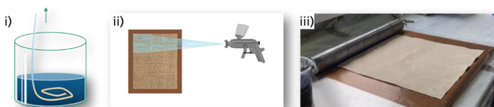
Abbildung 24: Darstellung der Beschichtungsmethoden. Links: Eintauchen der einzelnen Garne in Harz mit anschließendem Abstreifen überschüssiger Harzreste; mittig: Sprühbeschichtung der textilen Halbzeuge durch Sprühpistole und Holzrahmen; rechts: Walzbeschichtung.
