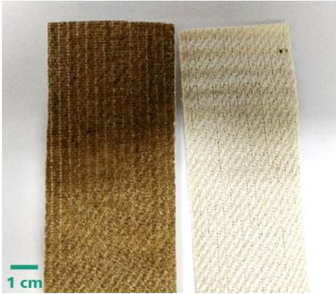
Abbildung 9: Abbildung von Epoxidharz-beschichtetem Flachs vor (links) und nach (rechts) einem Alkalidauertest bei 60 °C und pH_{\text{Start}} = 13 nach 30 Tagen.
