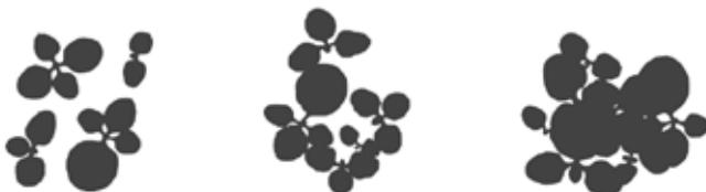
Testszenerien (Auswahl) zur Überprüfung der Algorithmgüte mit 0, 1 und 32 % Überlappung (v. l. n. r.)
