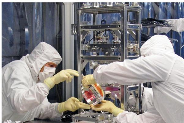
**Zwei LIGO-Techniker installieren die Optik zur Bereinigung der Moden (Foto: LIGO Laboratory).**
