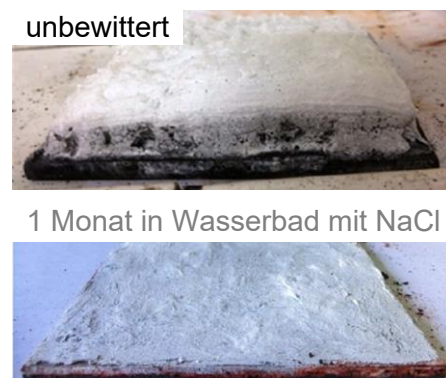
Abbildung 2.17: Versuchsergebnisse von Jimenez et al. (2013) von einer unbewitterten und einer für einen Monat in ein Wasserbad mit Natriumchloridlösung (5 g/l) getauchten Stahlplatte mit einer epoxidharzbasierten Beschichtung (TSD = 1,5 mm)
