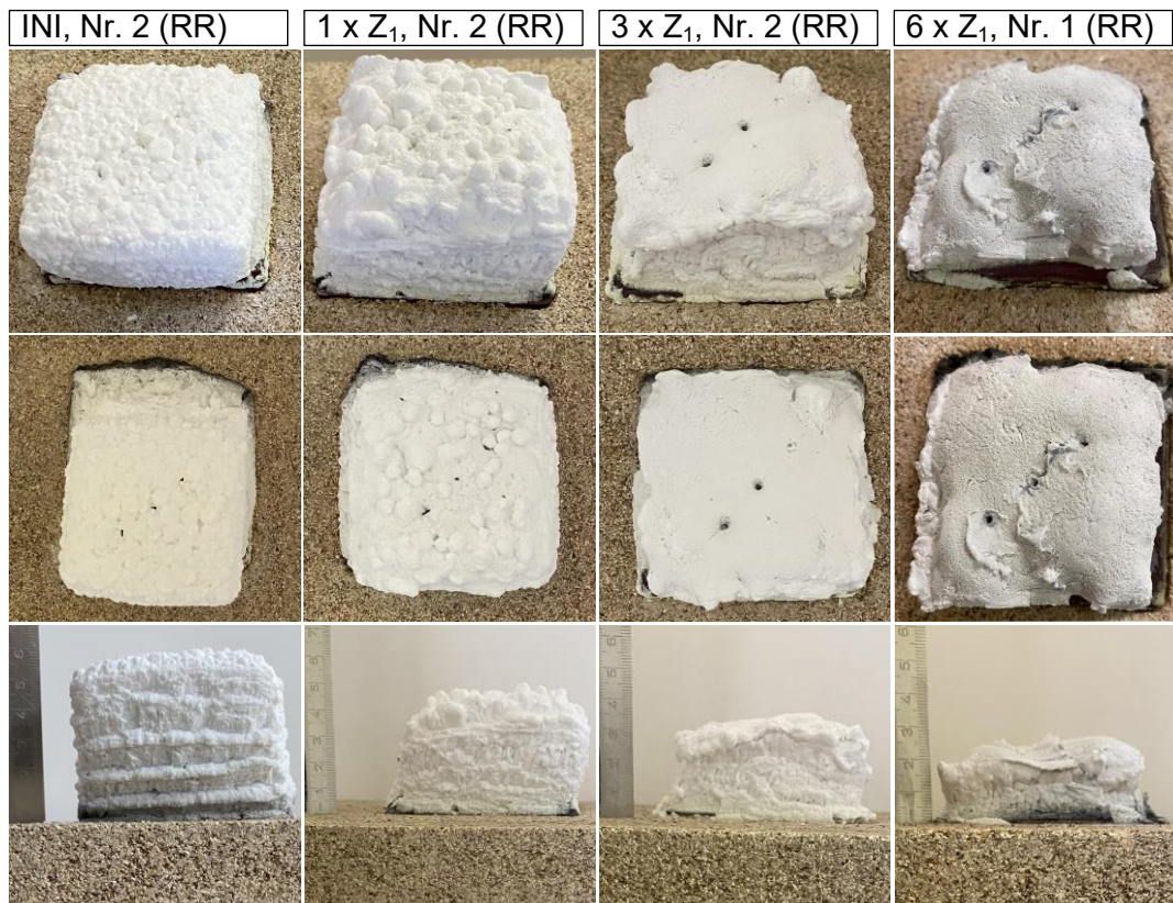
Abbildung 3.20: Übersicht über repräsentative Probekörper der Erwärmungsversuche mit der wasserbasierten Richtrezeptur (RR) nach dem Brandversuch
