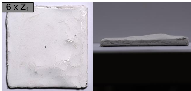
Abbildung 3.3: Detailbetrachtung eines ausgewählten Probekörpers beschichtet mit der wasserbasierten Richtrezeptur nach der Bewitterung gemäß 6 \times Z_1
