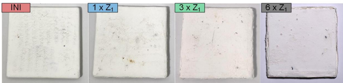
Abbildung 3.2: Aussehen der Oberfläche der Probekörper beschichtet mit der wasserbasierten Richtrezeptur nach der Bewitterung (Anmerkung: Eine repräsentative Probe ist je Bewitterungsstufe dargestellt. Verfärbungen der Probekörper sind auf Verunreinigungen durch die Handhabung zurückzuführen.)
