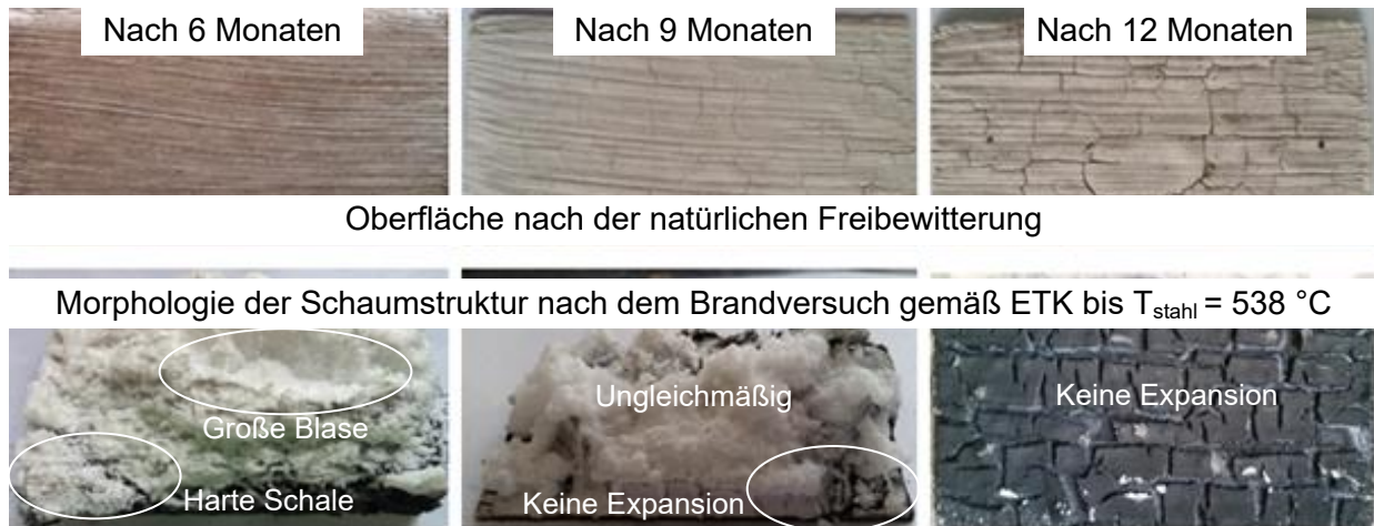
Abbildung 2.26: Probenoberfläche nach der Freibewitterung für 6, 9, 12 Monate sowie Morphologie der Schaumstruktur nach dem Brandversuch für ein wasserbasiertes RBS ohne Decklack (TSD = 1,2 mm) von Wang, J. (2016)
