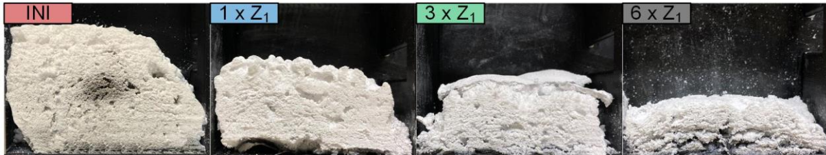
Abbildung 3.33: Darstellung repräsentativer Schnittflächen der Morphologie je Bewitterungsstufe der Probekörper mit der wasserbasierten Richtrezeptur (Anmerkung: Bei der Probe 6 x Z_1 fehlt die harte Schale an der Oberfläche)
