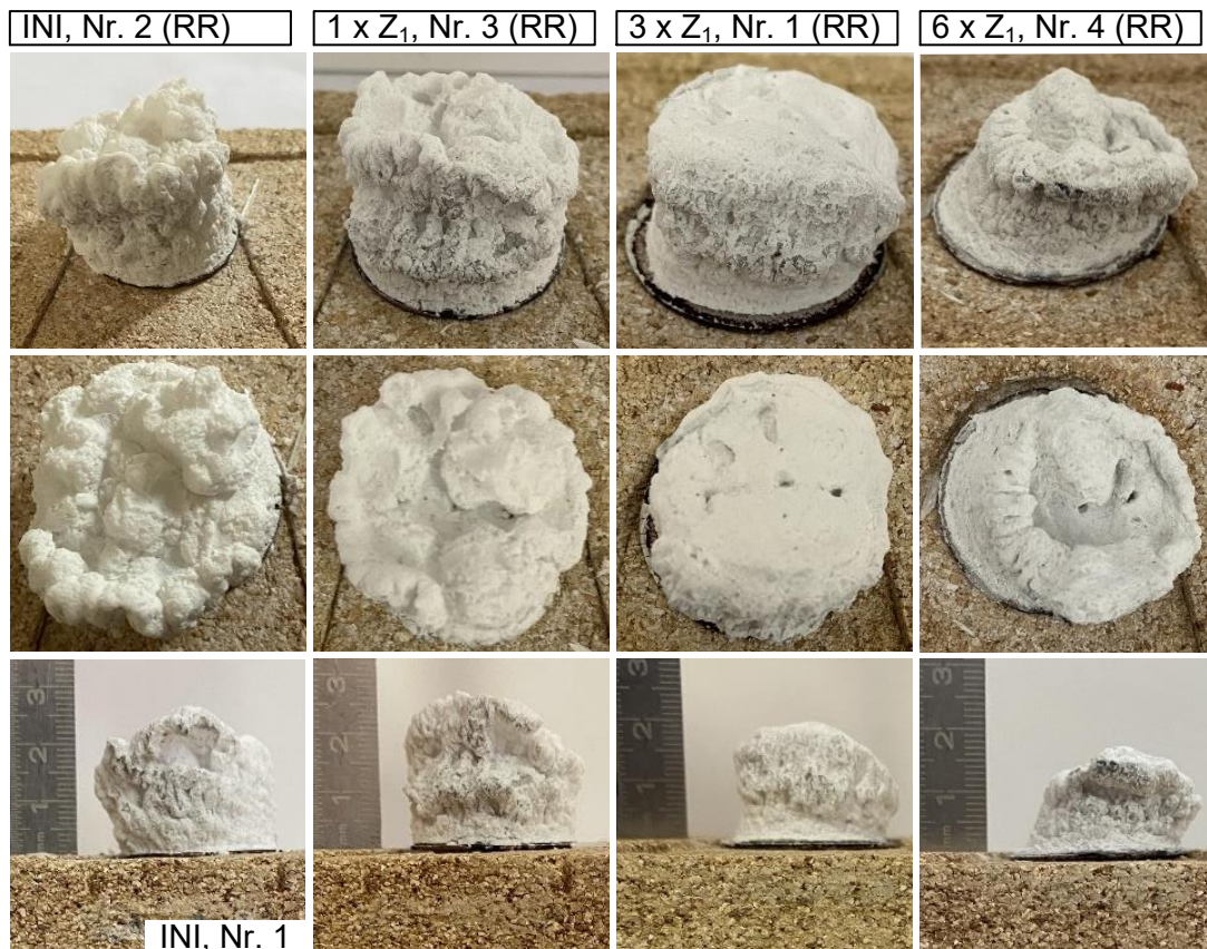
Abbildung 3.13: Übersicht über repräsentative Probekörper der Expansionsversuche mit der wasserbasierten Richtrezeptur (RR) nach dem Brandversuch
