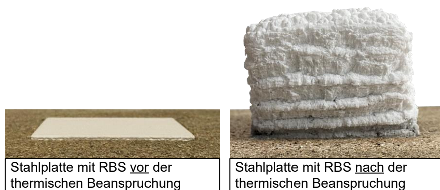
Abbildung 1.1: RBS vor und nach einer thermischen Beanspruchung
