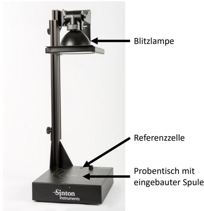
Abbildung 3.7.: Sinton WCT-120 Lebensdauer-Tester
