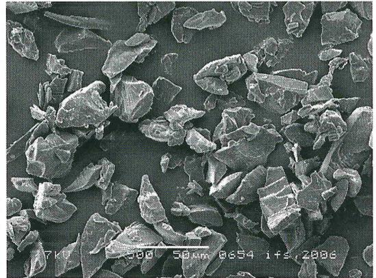
**Bild 2** REM-Aufnahme einer 32  $\mu\text{m}$ -Fraktion
