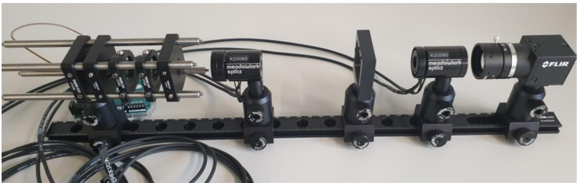
**Abbildung 5.4:** Aufnahme des verwendeten MM-Polarimeters, installiert auf einer optischen Schiene. Von links nach rechts: LED (i), Köhler'scher Beleuchtung (ii), PSG (iii), Probenhalterung (iv), PSA (v) und Kamera inklusive Objektiv (vi).
