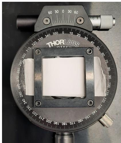
**Abbildung 5.10:** *High-Precision Rotation Mount* mit fixierter Vlies-Probe. Die elektrogesponnene PCL-Probe ist mit Hilfe eines Rahmens auf der Oberseite der *Rotation Mount* befestigt.
