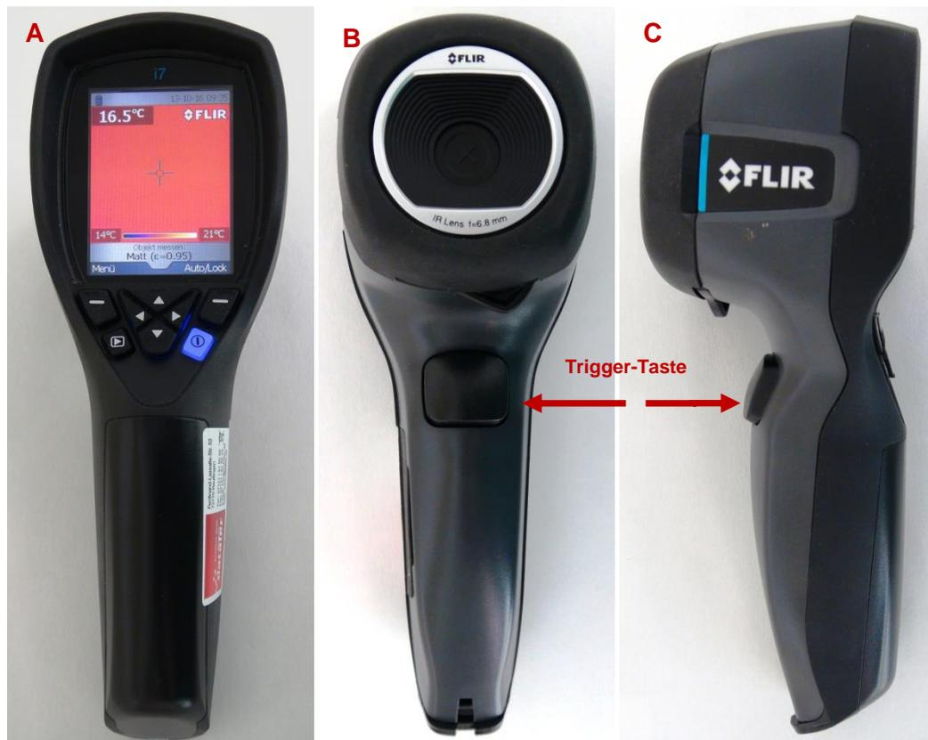
Abbildung 6: Im Versuch verwendete Bolometerkamera i7 (FLIR systems Inc., USA). Die Maße der Kamera betragen 223 x 79 x 83 mm. (A) Kamera von hinten mit einem aktivierten Bildschirm; (B) Kamera von vorne mit einem Infrarotobjektiv und Trigger-Taste zum Speichern von Bildern; (C) Kamera von der Seite
