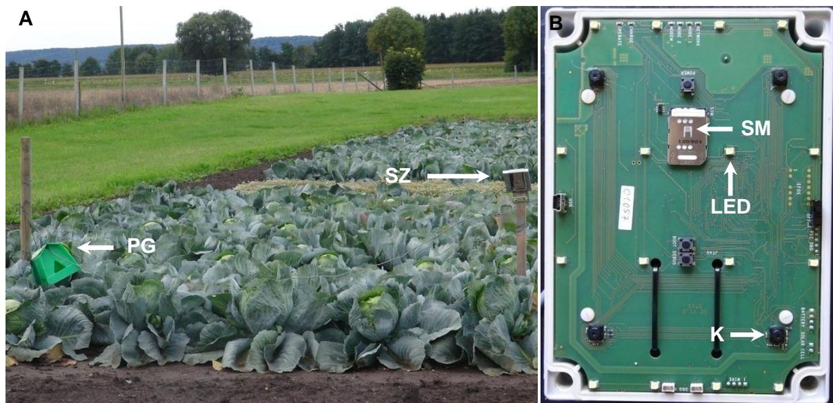
**Abbildung 17:** TrapView in einem Weißkohlfeld (A). TrapView bestand aus einem Plastikgehäuse (PG), Solarzelle (SZ) und einer (B) elektronischen Einheit. Die elektronische Einheit befand sich im Plastikgehäuse. K = Kameras, LED = LED, SK = SIM-Karte
