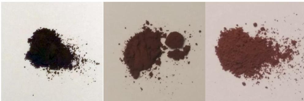
**Abbildung 4.1:** Fotografische Aufnahme der verwendeten Materialien, 3-fache Vergrößerung. Von links nach rechts: k-Magnetit, k-Hämatit, s-Hämatit.
