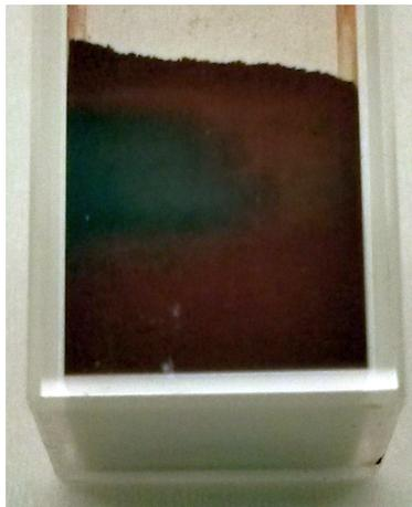
**Abbildung 4.2:** Fotografische Aufnahme einer Probe von k-Hämatit nach der Messung im Laser. Die Probe wurde bei einer Energie von ca. 8 mJ/Schuss mit etwa 20 Laserpulsen bestrahlt.
