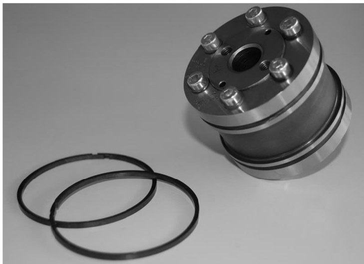
Abbildung 3.1: Rechteckdichtungen und Prüfwellen für Bauteilversuche am Funktionsprüfstand
