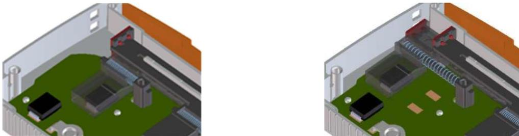
Bild 4: Aufbau der VTV auf Leiterplatte - Normalzustand (links); getrennter Zustand (rechts)
