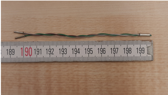
(a) 10 cm lange leerlaufende Zweidrahtleitung
