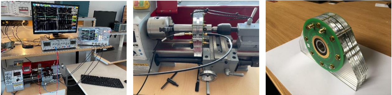
Bild 6: Prototyp der Messplatten und des Aufbaus
