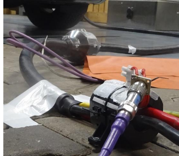
Bild 1: Schematischer Aufbau zur induktiv entkoppelten Messung der CM-Impedanz am aktiven System (links) und Realisierung des Messaufbaus unter Verwendung eines Ringkerntransformators (rechts)
