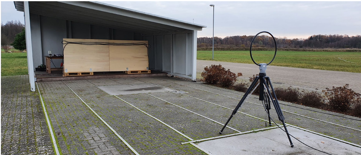
Bild 2: Messaufbau im Freifeld mit langer Versorgungsleitung, links Frequenzumrichter, rechts Versorgung
