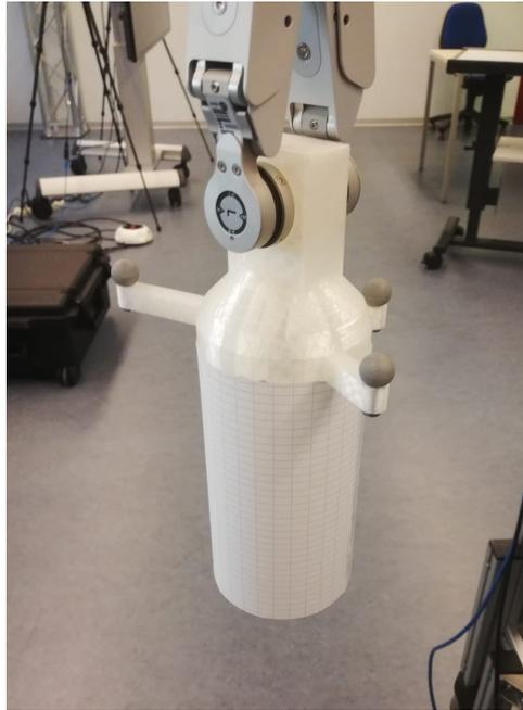
Abbildung 6.33: Vom End-Effektor gegriffenes Kalibriertarget.
