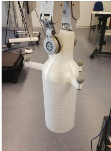
Abbildung 6.4: Vom End-Effektor gegriffenes Kalibriertarget mit Papierummantelung.
