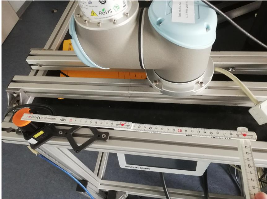
Abbildung 2.6: Manuelle Kalibrierung zwischen Laserscanner und Manipulator
