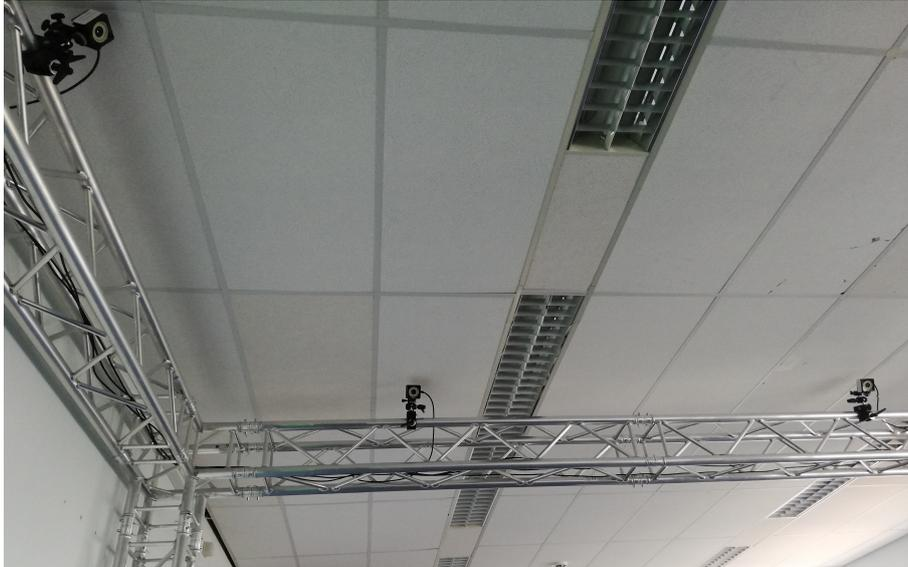
(a) An Traverse fixierte Tracking Kameras zur Bestimmung der Basis-Koordinatensysteme und Pose des Kalibriertargets
