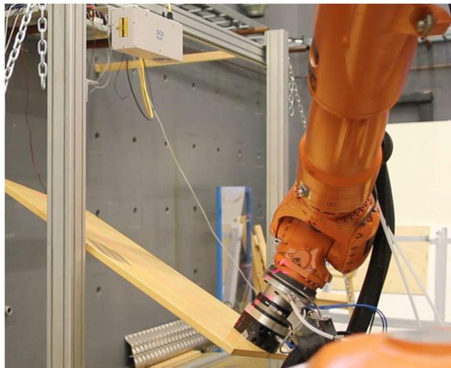
Abbildung 2.10: Aufbau des Kalibrierverfahrens mittels planarem Kalibriertarget und einem 2D Laserscanner auf einer Laufschiene [Hei+14]
