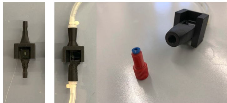
Abbildung 4.10.: Installation von verschiedenen Schläuchen an die Messzelle. Messzelle mit integrierter Schlaucholive zum direkten Anschluss von Schläuchen (links). Verschiedene Adapter zum Anschluss von Schläuchen mit kleineren Abmessungen (rechts).
