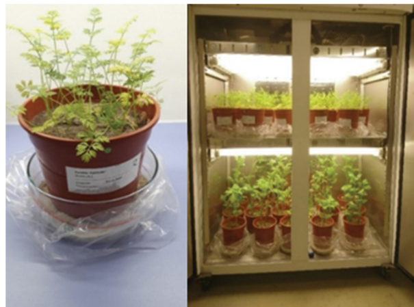
Abbildung 32 links: Aufbau der Pflanzenversuche in Glasschalen mit einem Sandbett zur Bewässerung von unten. rechts: Unterbringung der Pflanzen in der Phytokammer zur Regulierung der Temperatur und Tag/Nacht-Länge.
