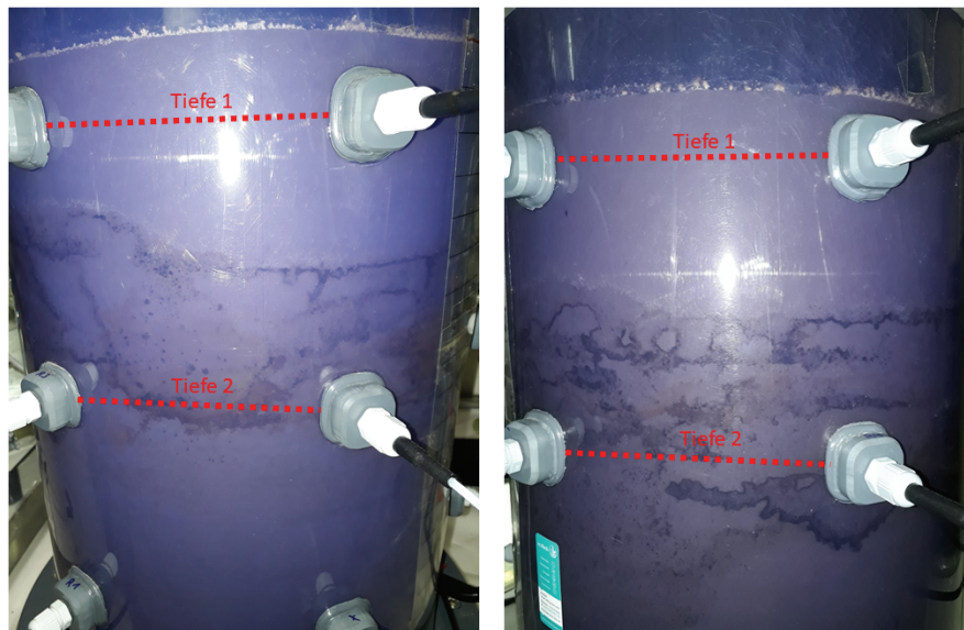
Abbildung 42 Seitenansicht des Lysimeters mit Blick auf Tiefe 1 und Tiefe 2. Im Bereich oberhalb der Tiefe 2 sind deutliche Ablagerungen zu erkennen, die aufgrund ihrer Verteilung auf einen schwankenden Wasserspiegel schließen lassen.
