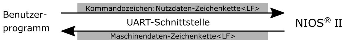
Abbildung 7.8: Veranschaulichung der Kommunikation zwischen Benutzerprogramm und Prozessor-Struktur.
