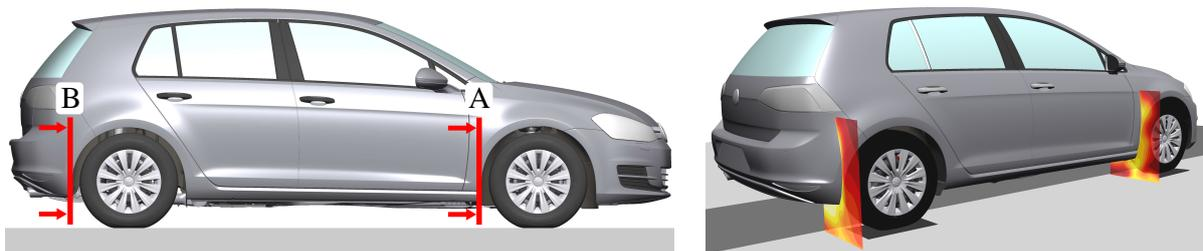
**Abb. 4.5:** Position der Messebenen im Radnachlauf in Versuch und Berechnung
