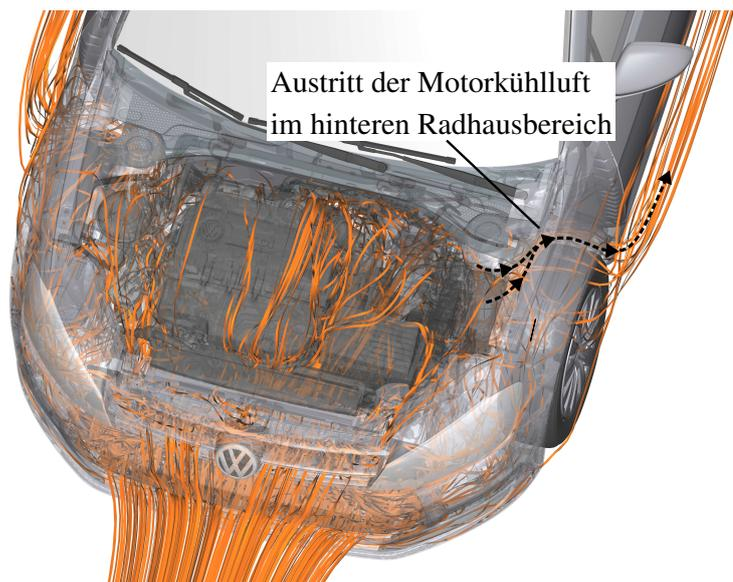
**Abb. 5.3:** Zeitgemittelte Stromlinien der Motorkühlluft
