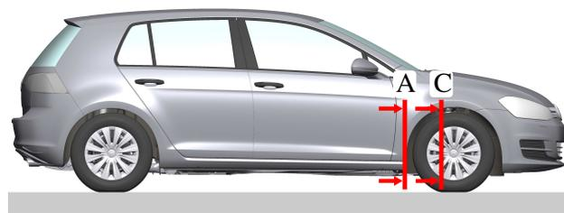
**Abb. 6.5:** Position der Analyseebenen in den Radnächläufen
