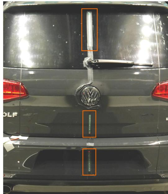
**Abb. 3.4:** DMS zur Messung des statischen Drucks im Mittelschnitt des Hecks
