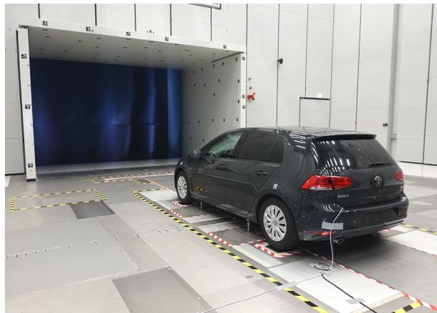
**Abb. 3.1:** Fahrzeugwindkanal von Volkswagen
