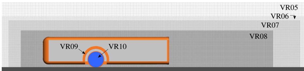
**Abb. A.6:** Verschachtelung der Netzverfeinerungsregionen (VR05 bis VR08) sowie lokal höher aufgelöste Bereiche (VR09 und VR10) beim Fabijanic-Modell
