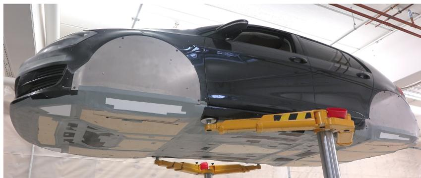
**Abb. 4.3:** Grundkörper des Golf 7 ohne Räder, mit geschlossenen Radhäusern und geglättetem Unterboden (Konfig. 1)
