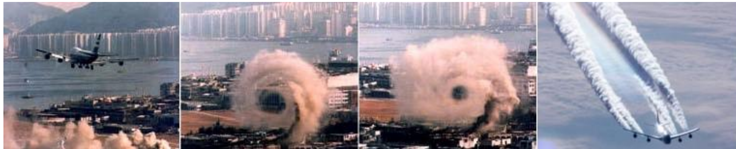
Bild 7.10: Das Bild zeigt den Effekt der Wirbelschleppe (auf den Rauch eines Brandes) einer ca. 350 Tonnen schweren B747 im Anflug auf den alten Flughafen KaiTak in Hongkong Quelle: Widema, http://www.widema.de/fluchlaerm/informationen/gutachten/wirbelschleppen.html /9/
