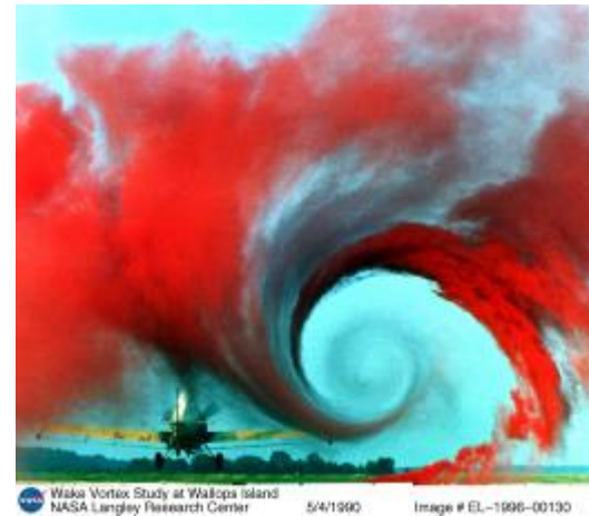
Bild 7.9: Wirbelschleppenausprägung Quelle: NASA Langley Research Center
