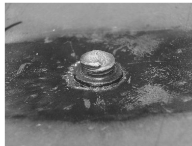
b) Ladespannung 200 V: Bruchlage im Bolzen nach Biegewechselprüfung
