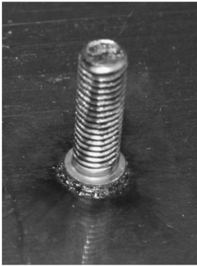
a) Schweißspuren durch Nebenlichtbögen
