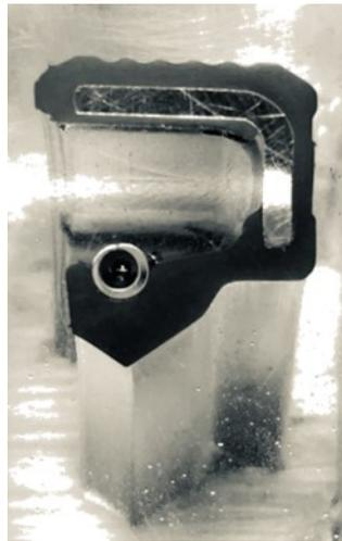
Abbildung 5.2: Schliffbild einer Prüfdichtung; eingegossen in Kunstharz
