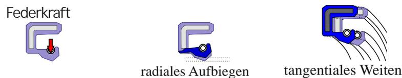
Abbildung 4.14: Ursachen für die Entstehung der Radialkraft
