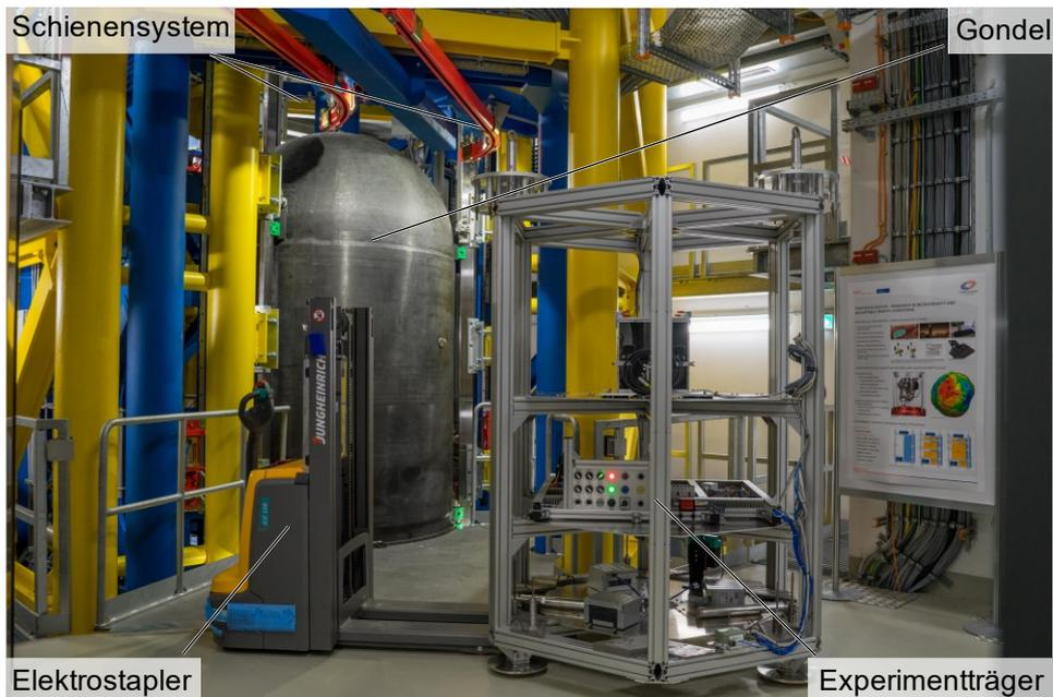
**Abbildung 4-17:** Beladeebene des Einstein-Elevators mit Experimentträger, Elektro stapler, Schienensystem (Bildquelle: [Kol19], Ausschnitt, Beschriftung ergänzt)
