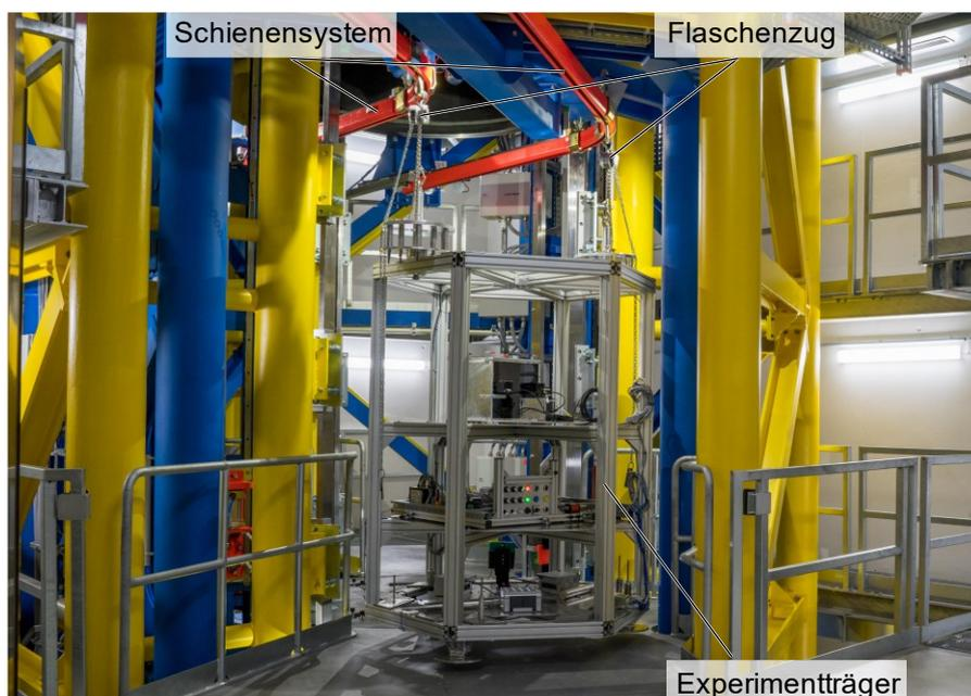
**Abbildung 4-18:** Beladeebene des Einstein-Elevators mit ausgefahrenem Schienensystem und eingehängtem Experimentträger (Bildquelle: [Kol19], Ausschnitt, Beschriftung ergänzt)
