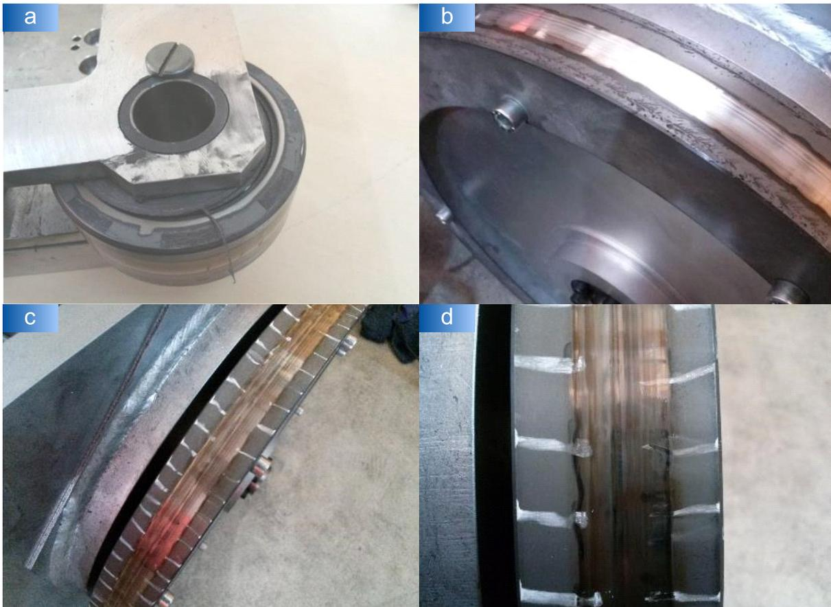
**Abbildung 6-18:** Verschleißuntersuchung an einer Laufrolle und einem Laufring nach 25.000 Fahrten im Zeitrafferverfahren, a) Laufrolle mit gelöster Deckscheibe, Span an der Deckscheibe und verteiltem Schmiermittel, b) Laufspuren auf dem Laufring, c) Laufring mit markierten wellenförmigen Spuren auf dem Umfang, d) Detailsansicht der wellenförmigen Spur auf der Laufringoberfläche (Quelle: nach [Lot15])
