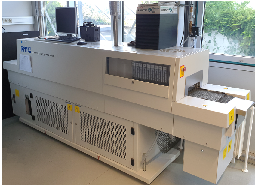
Abb. 3.5.: Fotoaufnahme des RTC Bandofens Model LA-310, der zum Tempern von Proben eingesetzt wurde.
