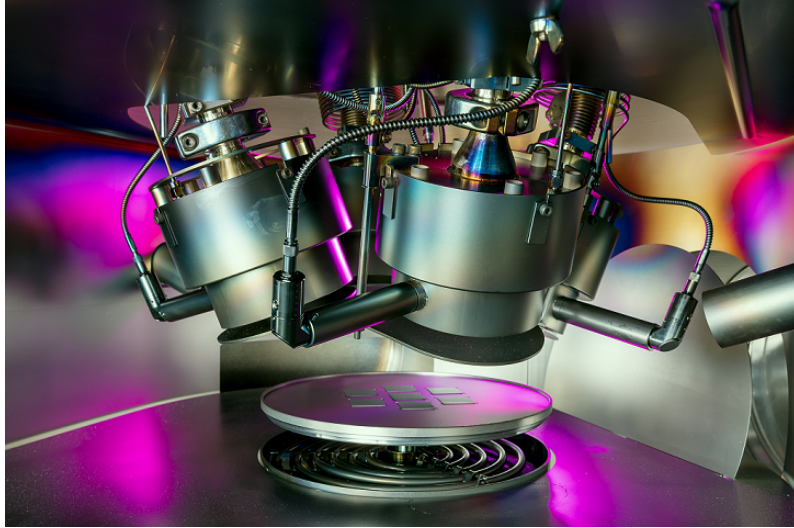
Abb. 3.2.: Fotoaufnahme vom Inneren der Prozesskammer der Co-Sputteranlage der Firma DREEBIT GmbH, ©ISFH (Foto von Salzmann Fotografie).
