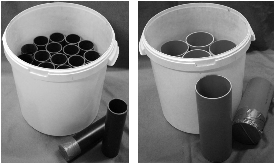
Abbildung 3-1: Schalungspräparation mittels PVC-Rohre links Größe G-3 und rechts Größe G-2, aus HÜMME (2018)
