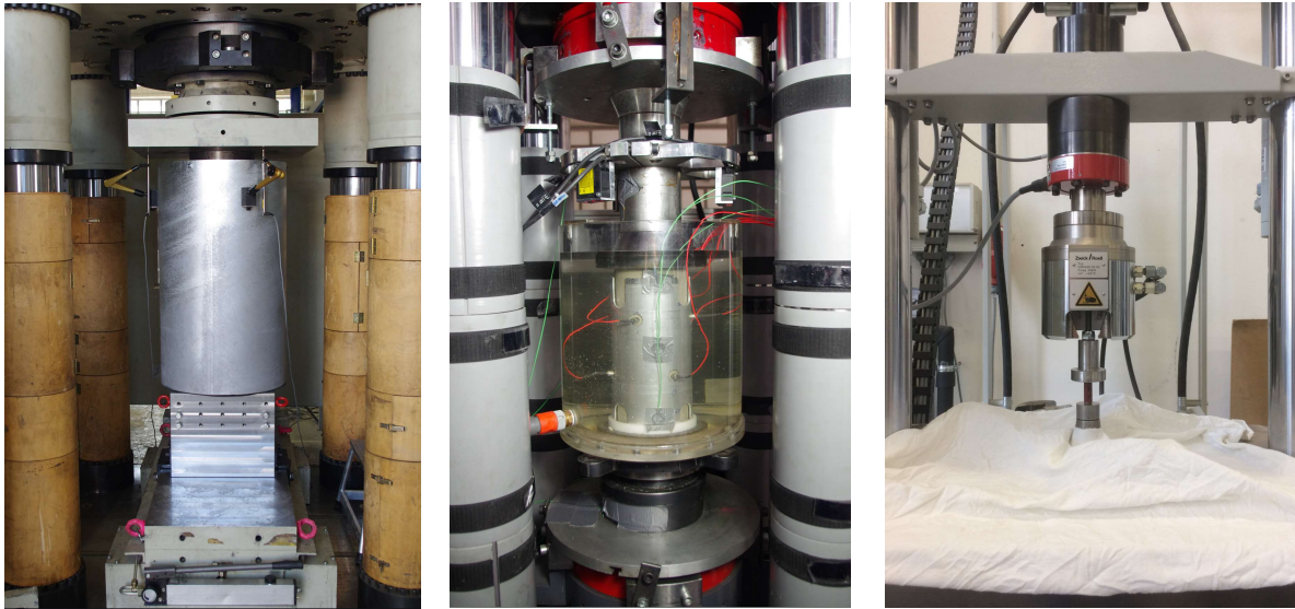
Abbildung 3-7: Versuchsaufbauten links: 10 MN Prüfmaschine, Mitte: 2,5 MN Prüfmaschine, rechts: 10 kN Prüfmaschine
