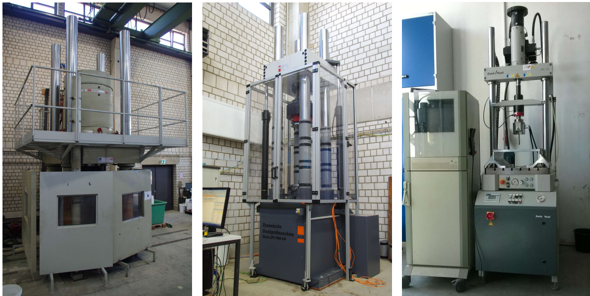
Abbildung 3-5: Servo-hydraulische Prüfmaschinen links: 10 MN Prüfmaschine, Mitte: 2,5 MN Prüfmaschine; rechts: 10 kN Prüfmaschine
