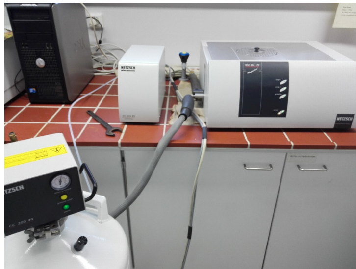
Abbildung 3.13: Versuchsaufbau des „Netzsch DSC 204 F1 Phoenix®“
