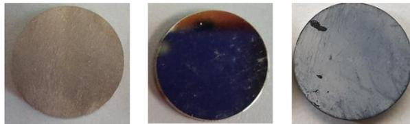
**Abbildung 49:** unpolierte Titanprobe (links), polierte Titanprobe **84** (Mitte), mit HMDSO-modifizierte Titanprobe **86** (rechts).
