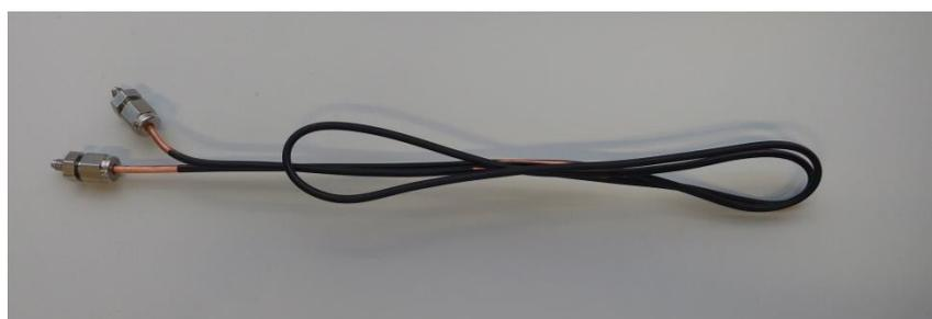
**Abbildung 17:** 1/8"-Kupferschleifenreaktor (4 Schleifen,  $V = 2.0 \text{ mL}$ ).
