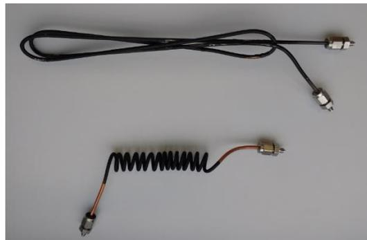
**Abbildung 18:** Schleifenreaktor (oben) und gewickelter Reaktor (unten).
