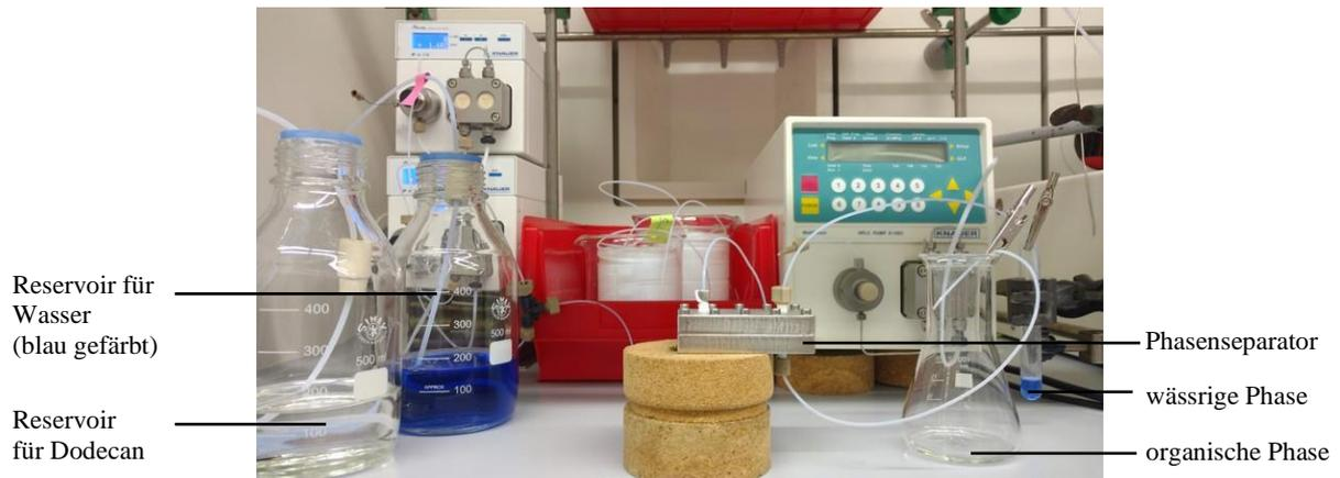
**Abbildung 27:** Versuchsaufbau mit Phasenseparator zum Trennen von Wasser (mit Tinte gefärbt) und Dodecan.
