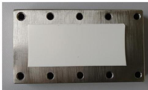
**Abbildung 25:** Separatorfläche und hydrophobe PTFE-Membran.
