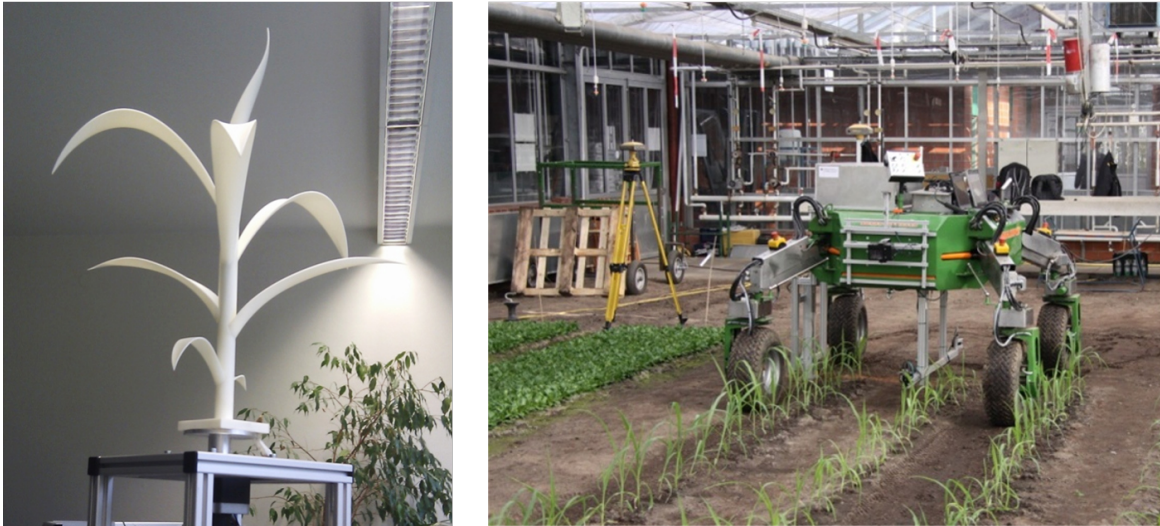
Abbildung 4.6: Apparaturen. Links: Messaufbau Rotationstisch mit künstlicher Maispflanze, Rechts: Autonomer Feldroboter BoniRob im Gewächshaus
