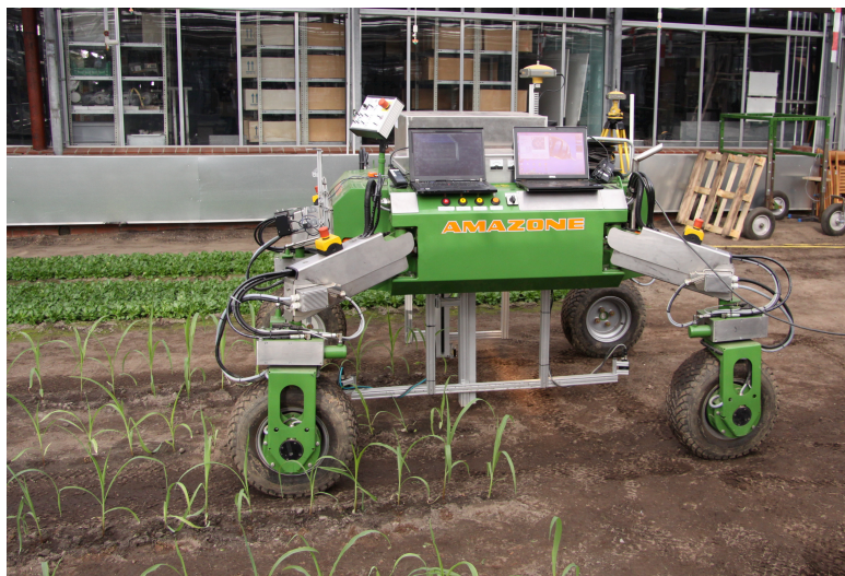
Abbildung 4.57: Automatische Top-View-Vermessung der Pflanzen
