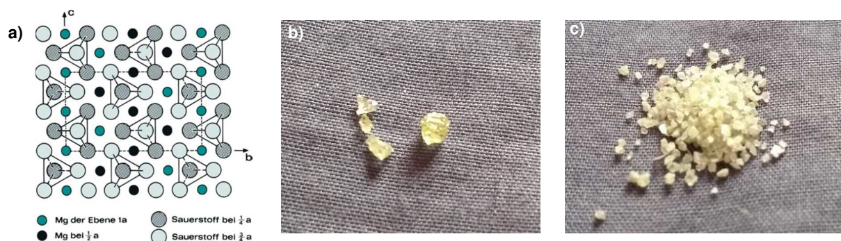
Abb. 17: Olivin - a) Schema der Kristallstruktur des Olivins (am Bsp. des Forsterits) in der Projektion (formale hcp der Sauerstoffatome der theoretisch isolierten und kovalenten SiO_4 -Tetraeder, Si formal auf 1/8 der Tetraederlücken und Mg^{2+} auf 1/2 der Oktaederlücken) (aus: [39]), b) Olivin als Kristallite (Herkunft: unbekannt), c) Olivinsand (Herkunft: unbekannt).
