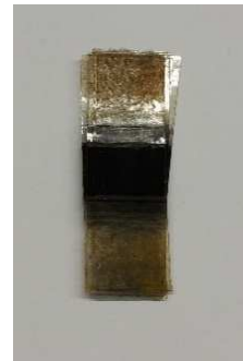
Abb. 31: Mittels Klebefilm-Methode präparierte Probe (Bsp. \text{Fe}_3\text{O}_4 Mikro-partikel).
