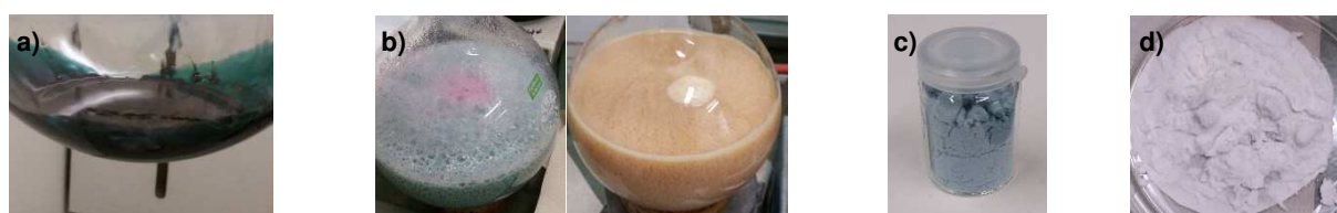
Abb. 60: Darstellung des Bzimpy – a) Reaktionsschmelze nach 5 – 6 h Reaktionszeit, b) Schmelze in Eiswasser und Rohprodukt in saurem pH-Bereich (links) und Start der Basenzugabe (links, rosafarbene Eintropfstelle der Base) sowie nach Erreichen eines neutralen bis schwach basischen pH-Milieus (rechts), c) Bzimpy aus Darstellung nach der hausinternen Vorschrift, d) Bzimpy aus der Darstellung nach der neu entwickelten Vorschrift.
