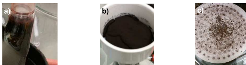
Abb. 54: Synthese des Porphins – a) Reaktionslösung nach vollständiger Zugabe des Formalins, b) abfiltrierte schwarz-braune Nebenprodukte, c) Porphin.
